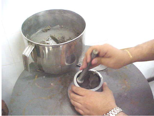
Figura 38 – Adensamento da argamassa TP em fôrma específica para a realização do teste de consistência.
