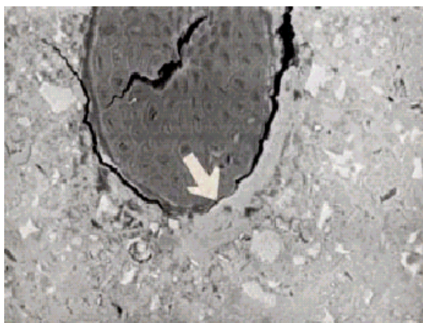
Figura 10 – Imagem por elétrons retroespalhados em compósito de cimento Portland e fibra de coco aos 28 dias. A seta indica a zona de transição fissurada. (Fonte: SAVASTANO, 1992).
