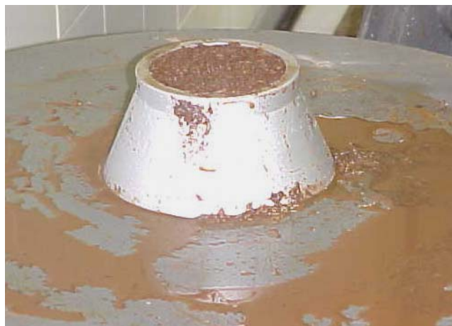
Figura 33 – Aspecto da fôrma e mesa para ensaio de consistência.
