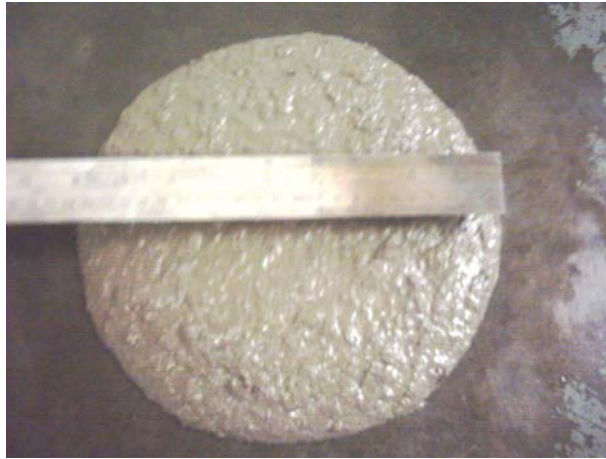
Figura 39 – Aferição do espalhamento da argamassa TP.
