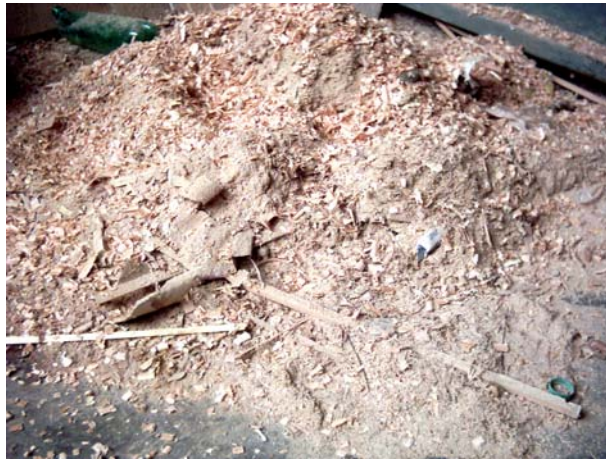
Figura 15 - Resíduos produzidos após corte de peças de madeira.
