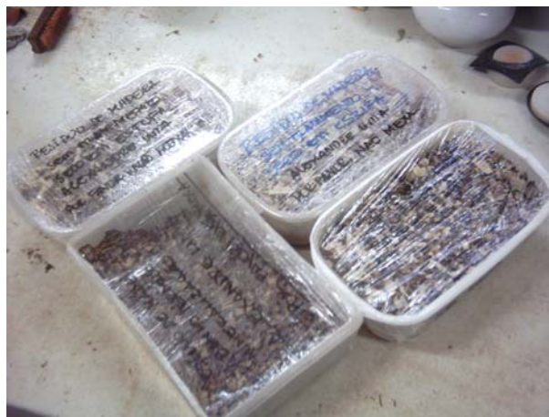
Figura 23 – Aspecto dos resíduos de madeira acondicionados em embalagens plásticas vedadas com filme de pvc após tratamento SE.
