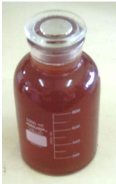
Figura 24 – Aspecto visual dos efluentes do resíduo de madeira coletado após o banho térmico
