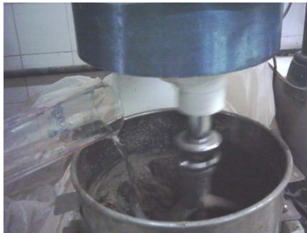
Figura 35 - Água aditivada sendo parcial e gradualmente adicionada a mistura cimento-areia.
