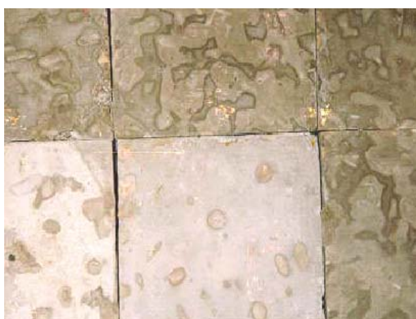
Figura 03 – Incompatibilidade entre a fibra do bambu e a matriz de cimento Portland (Fonte: Disponível em: < www.biokreto.com.br > Acesso em 21/11/2001).
