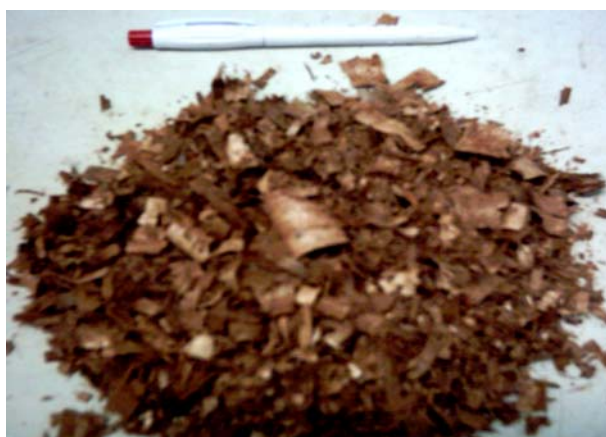
Figura 26 – Aspecto do resíduo de madeira depois do tratamento com banho térmico
