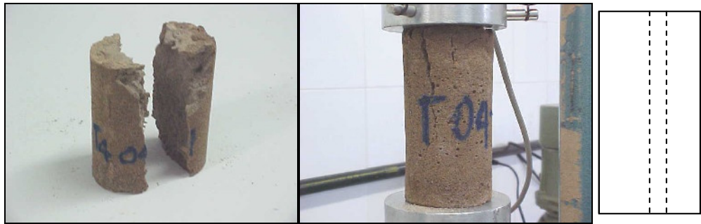
Figura 36 – Fissuração típica dos traços mais pobres em cimento
