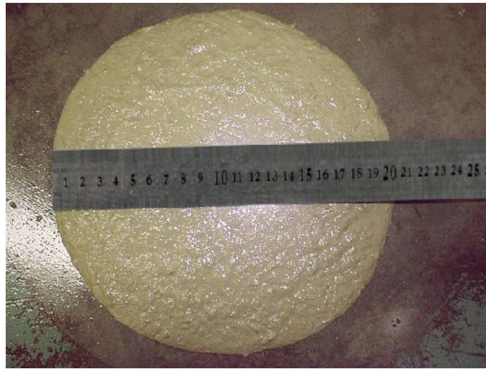
Figura 24 – Determinação do índice de consistência para o traço 1:3,5.
