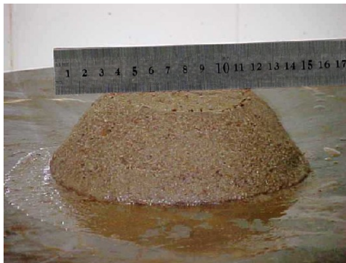
Figura 23 – Determinação do índice de consistência para o traço 1:5.
