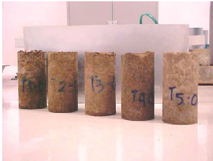
Figura 22 – Corpos-de-prova com fungos na superfície.
