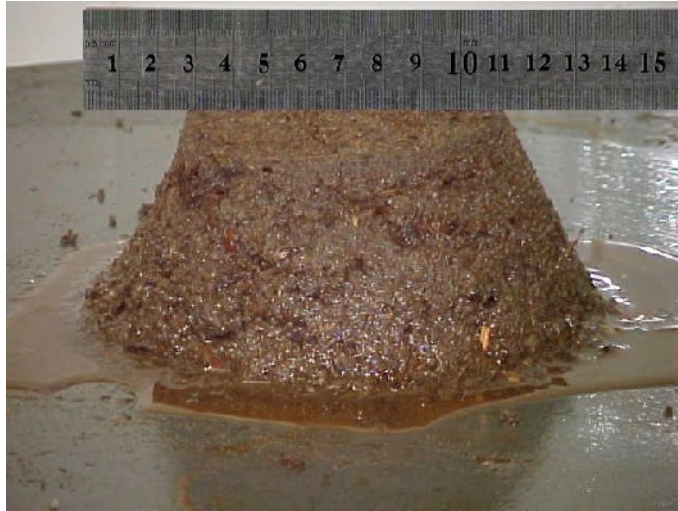
Figura 20 – Determinação do índice de consistência para o traço 1:6,5.
