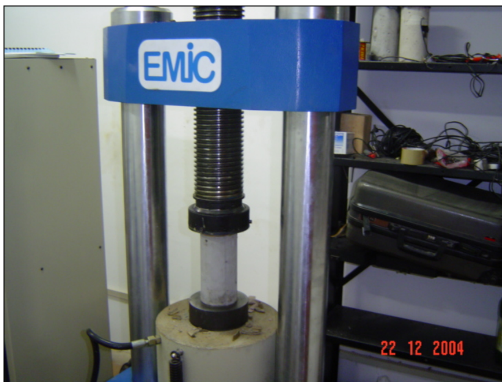
Figura 3.30 – Ensaio de resistência à compressão
