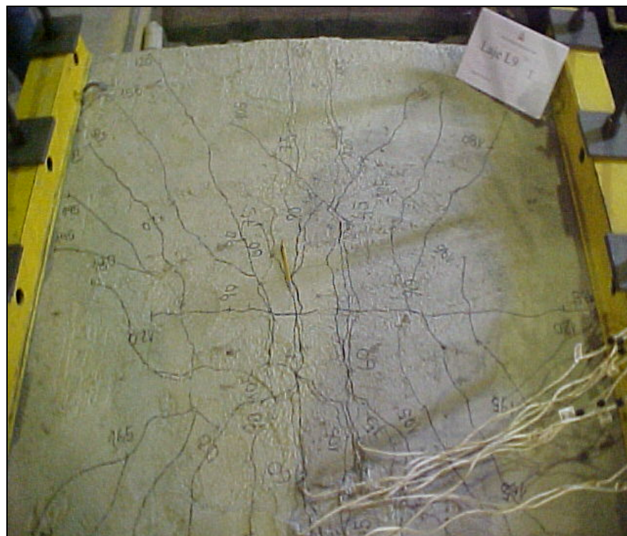
Figura 4.48 – Mapa de fissuração da laje L9
