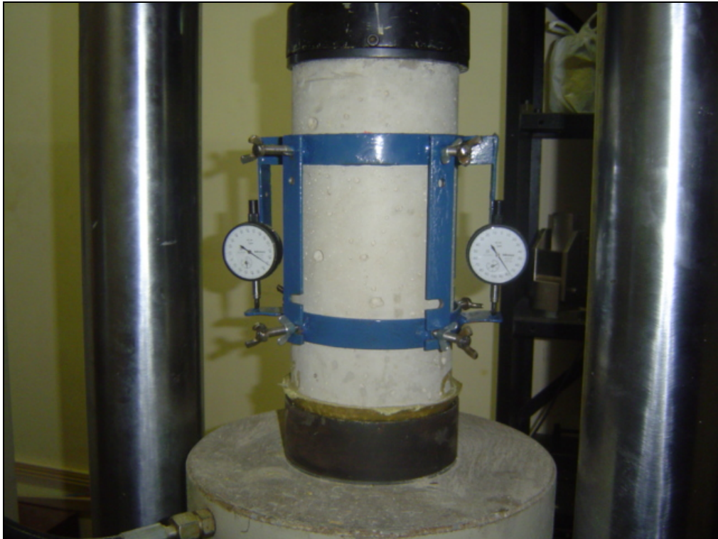
Figura 3.31 – Ensaio de Módulo de Elasticidade
