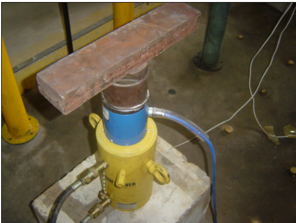
Figura 3.20 – Cilindro, célula de carga, rótula e placa metálica
