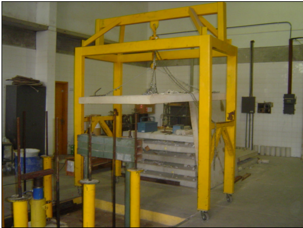
Figura 3.17 – Pórtico de transporte
