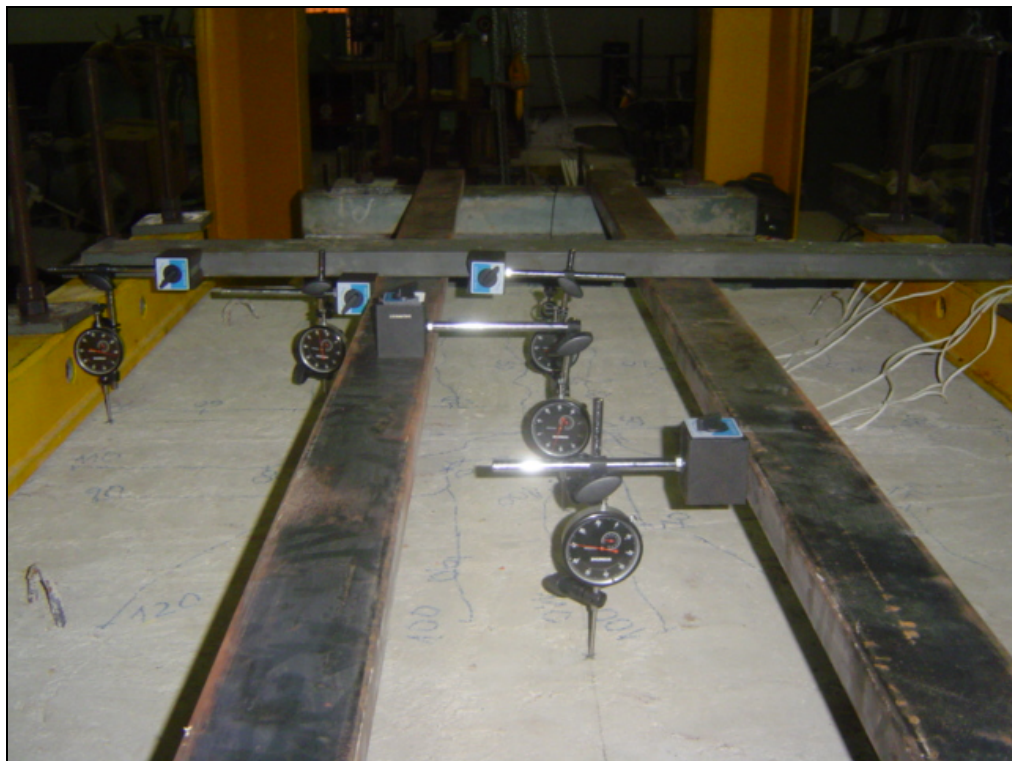
Figura 3.8 – Deflectômetros nas lajes
