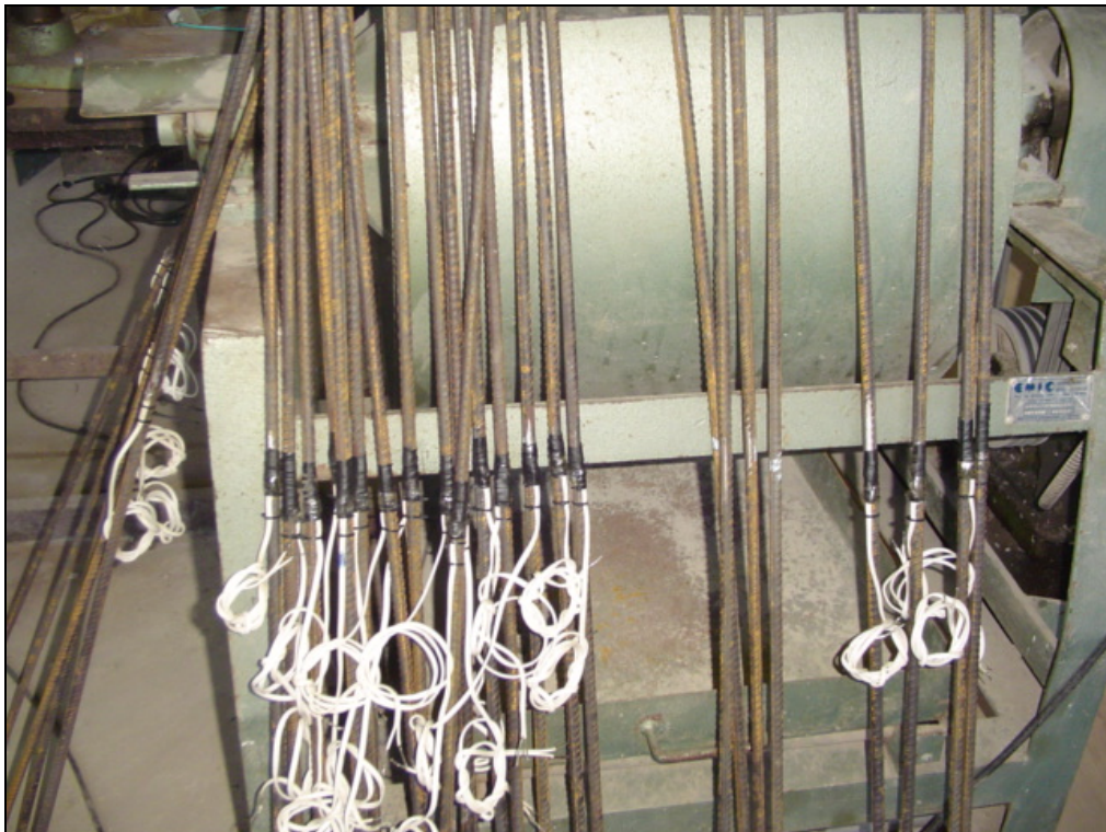
Figura 3.10 – Extensômetros no meio do comprimento das barras da armadura de flexão
