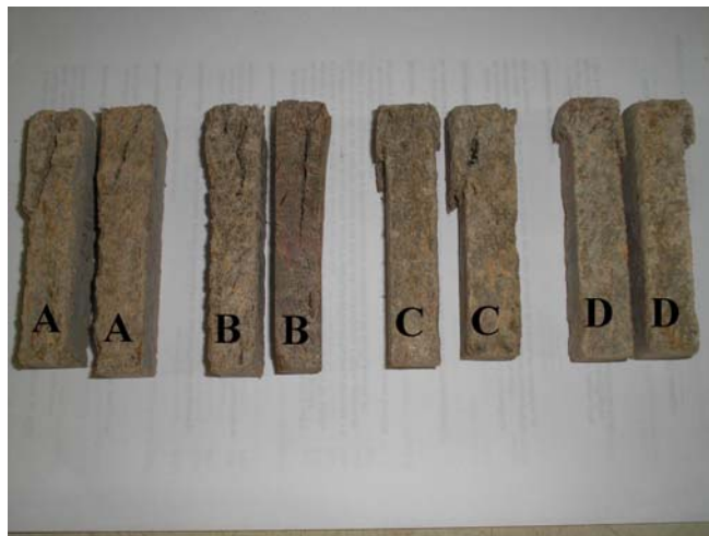
FIGURA 4.12 – Tipos de fissuras em corpos-de-prova no ensaio de compressão paralela
