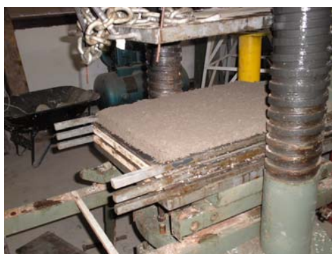
FIGURA 3.10 - Formação do colchão de cimento-madeira
