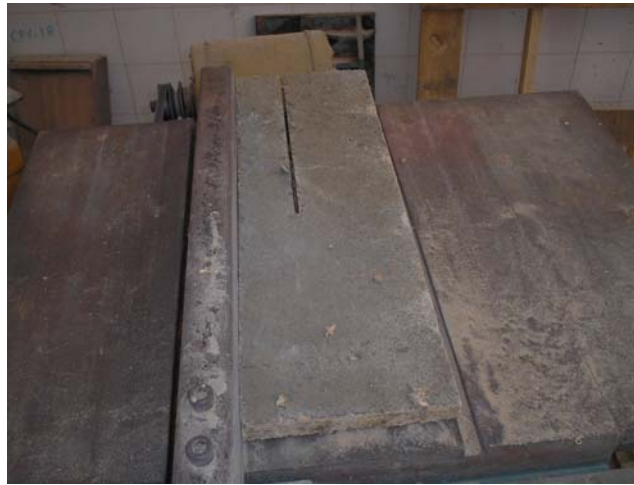
FIGURA 3.13 - Corte dos corpos-de-prova em serra circular
