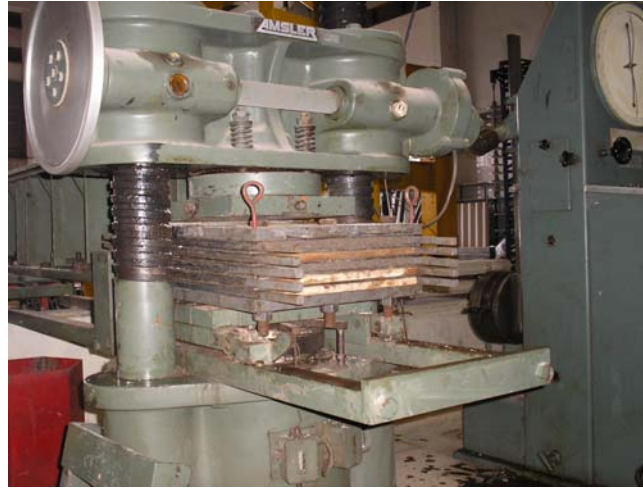
FIGURA 3.11 – Aplicação de pressão para fixação dos parafusos no molde
