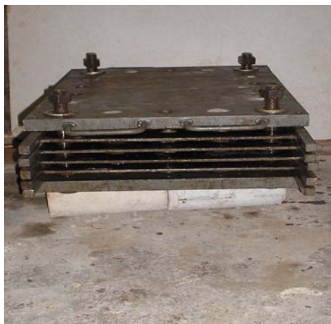
FIGURA 3.9 – Molde metálico para manufatura de chapas cimento-madeira
