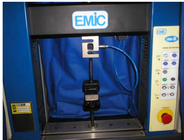
FIGURA 3.18 - Dispositivo para o ensaio de tração perpendicular
