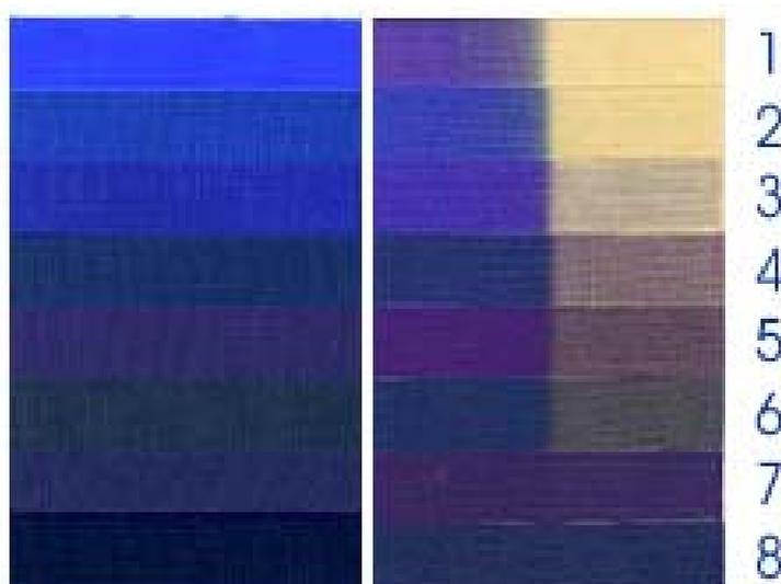
**Figura 3.2:** Escala de azuis ou escala de lã. a) Peças que não foram expostas à luz solar e que servem como referência; b) Peças expostas lado a lado à radiação solar por um período de dois anos, é possível ver claramente a perda de coloração dos pigmentos à esquerda da mesma. (internet: [http://www.cpsa.org/PRODUCT\\_RESEARCH/bluewool2.jpg](http://www.cpsa.org/PRODUCT_RESEARCH/bluewool2.jpg))
