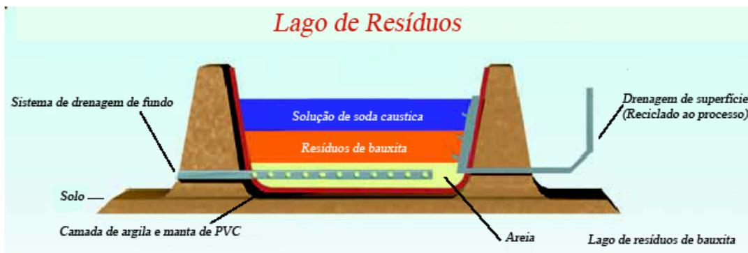
**Figura 2.4:** Esquema do lago de deposição de resíduos (*site da ABAL*)
