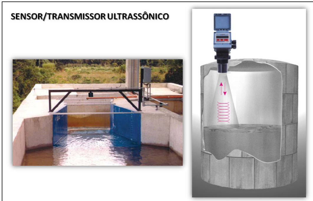
Desenho 7 - Medidor de nível ultrassônico. Fonte: Adaptado de Incontrol (2002b).
