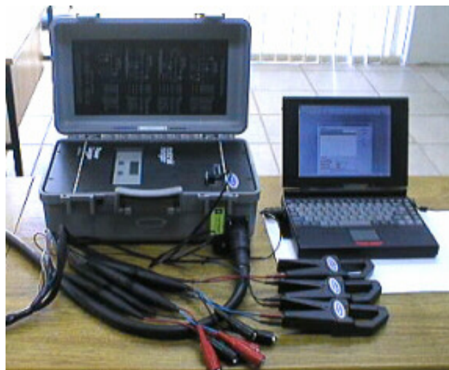
Fotografia 6 - Medidor de Consumo e Demanda de Energia Elétrica Fonte: Medidor (2007).
