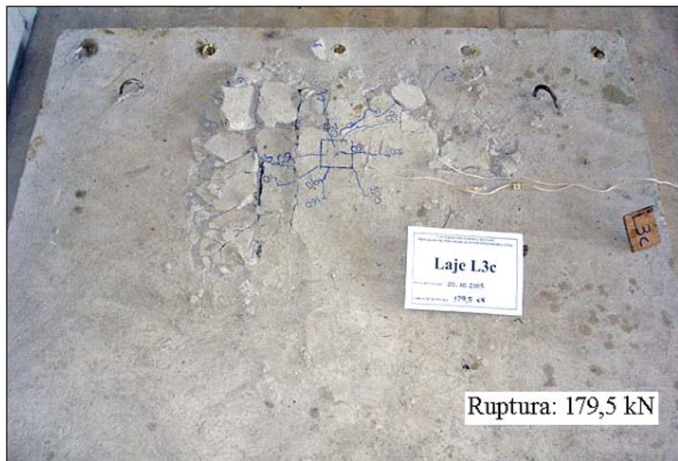
Figura 4.39 – Mapa de fissuração da laje L3c
