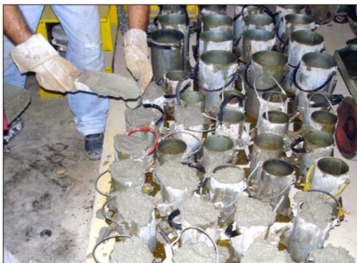
Figura 3.17 – Moldagem dos corpos de prova
