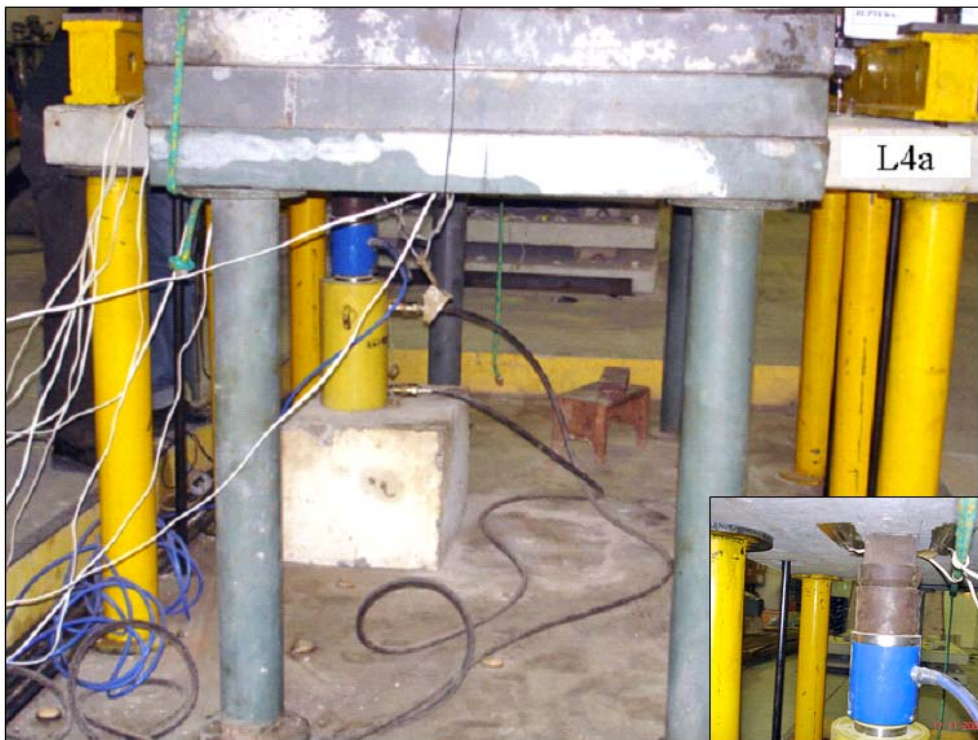
Figura 3.15 – Posicionamento do cilindro no ensaio da laje L4a
