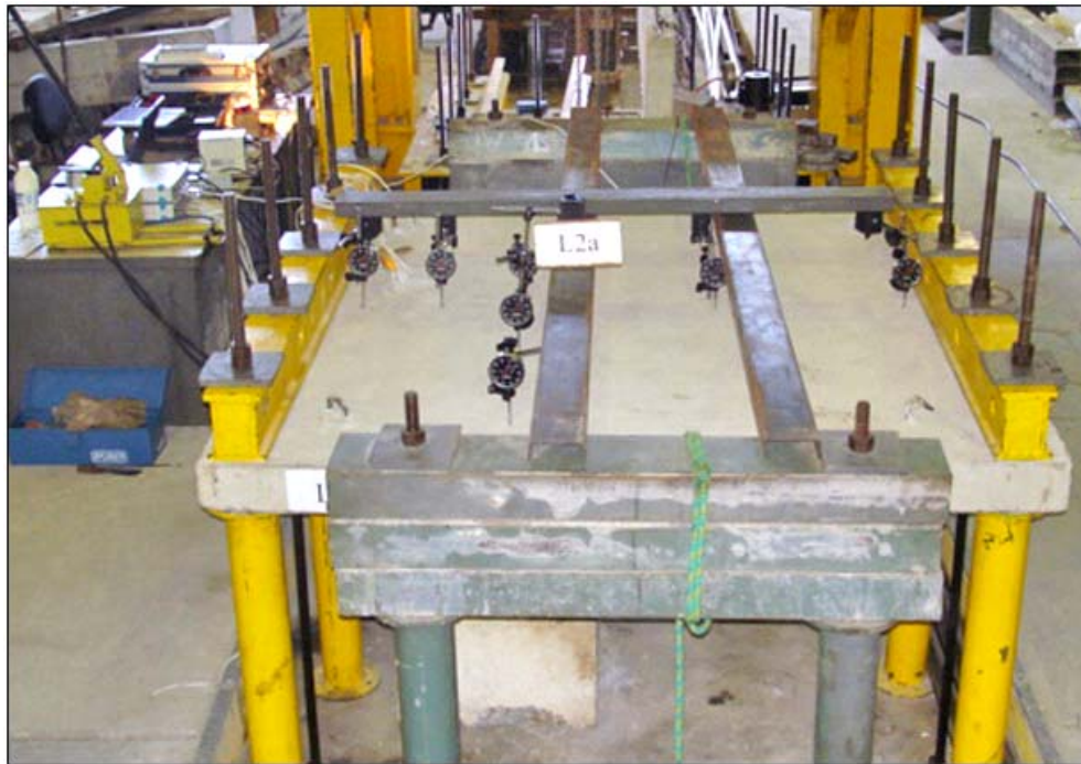
Figura 3.13 – Ensaio da laje L2a
