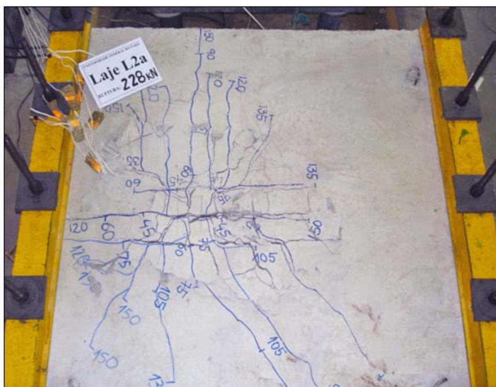
Figura 4.34 – Mapa de fissuração da laje L2a
