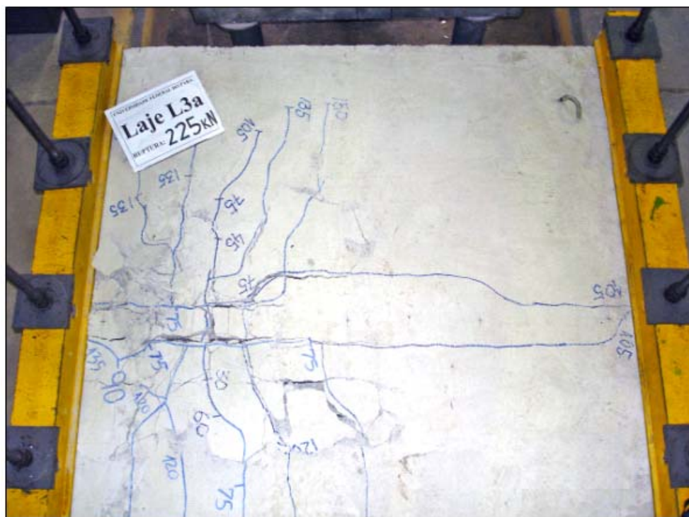
Figura 4.37 – Mapa de fissuração da laje L3a
