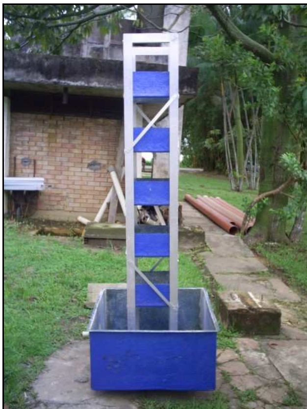
Fotografia 15 - Aerador tipo tabuleiro em fibra de vidro e estrutura em alumínio confeccionado para a ETA-Piloto.
