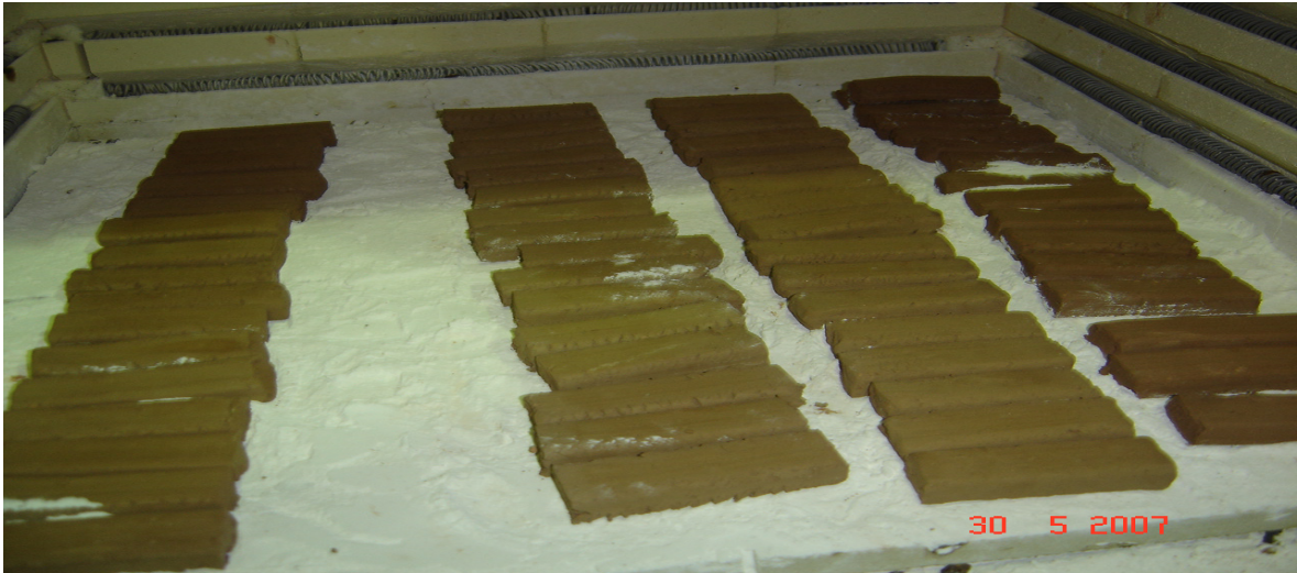
Foto 20: Corpos de prova após resfriamento dentro do forno (2007).
