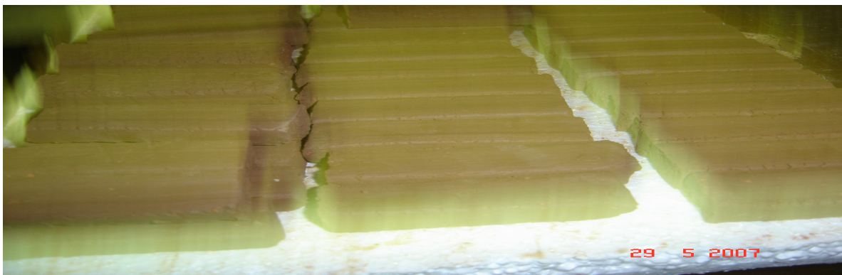
Foto 18: Corpos de provas colocados na estufa para secagem a 105°C (2007).
