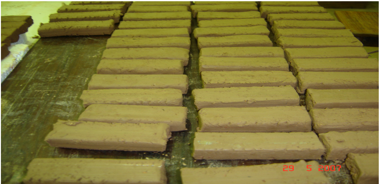
Foto 16: Corpo de prova depois de extrusado (2007).
