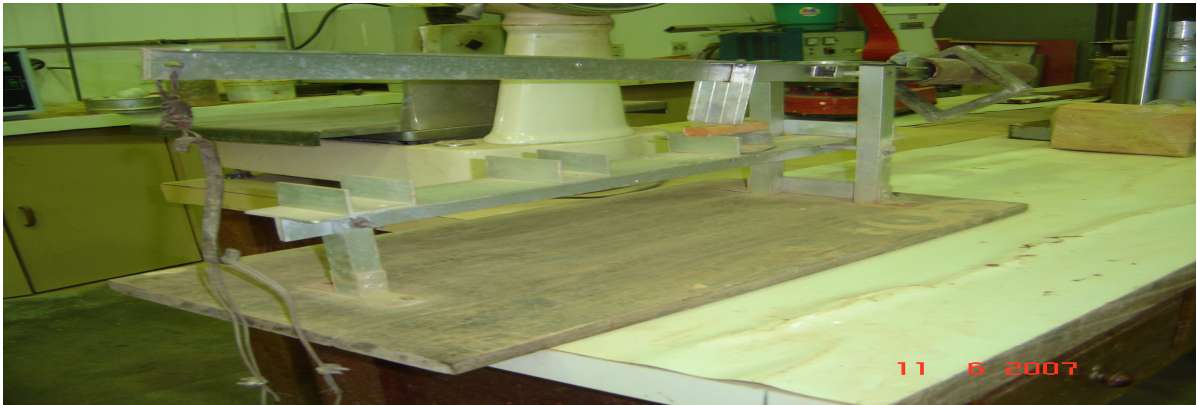
Foto23: Prensa para teste de tensão de ruptura a flexão. Laboratório de Engenharia Química UFPA (2007).
