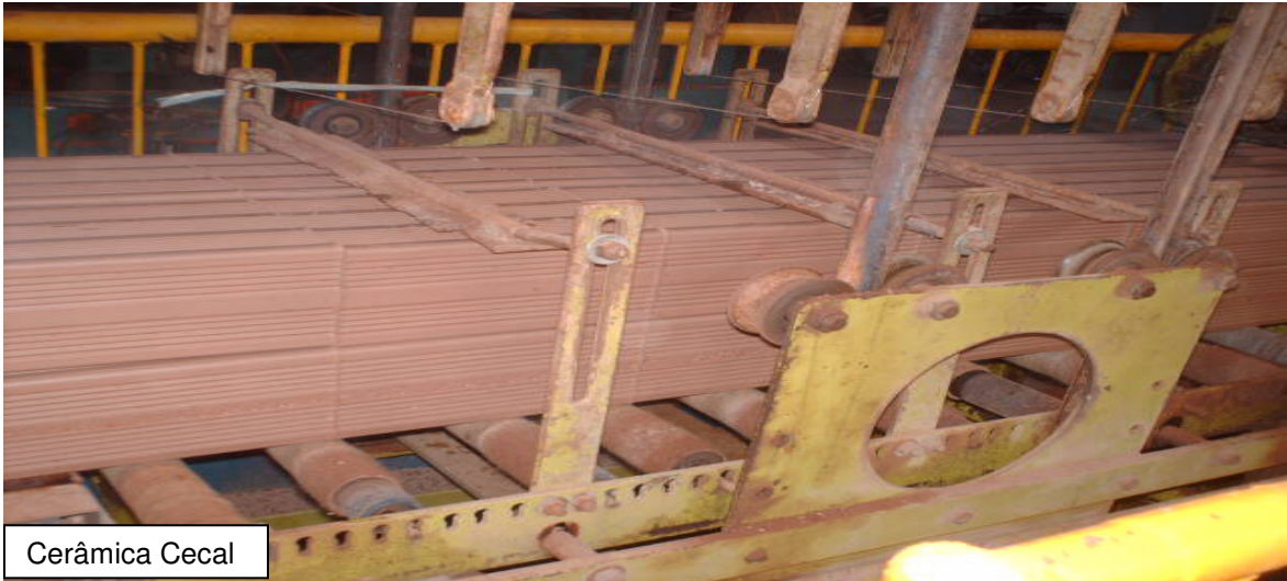
Foto 06: Corte automático com arames (Março 2007).
