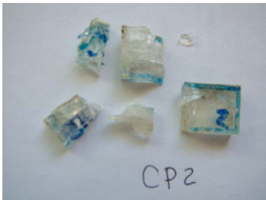
FIGURA 93 - Corpo de prova nº 2 da matriz de poliéster após ensaio de compressão: o corpo de prova foi quebrado em várias partes.
