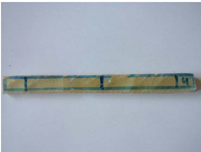
FIGURA 100 – Corpo de prova nº2 da matriz híbrida após ensaio de flexão: devido a lâmina interna de poliuretana o corpo de prova apresentou apenas trincas nas lâminas de poliéster.
