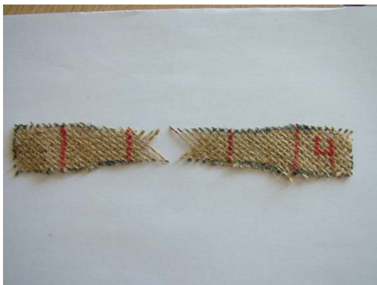
FIGURA 84 – Corpo de prova nº 4 do tecido de juta com fios da trama a 45°: por não estarem paralelos à solicitação dos esforços apresentou pequena resistência à tração.
