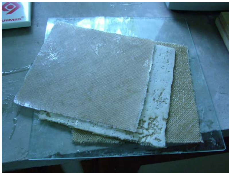
FIGURA 72 – As três lâminas prontas do compósito: a interna, de poliuretana e as duas externas, de poliéster.
