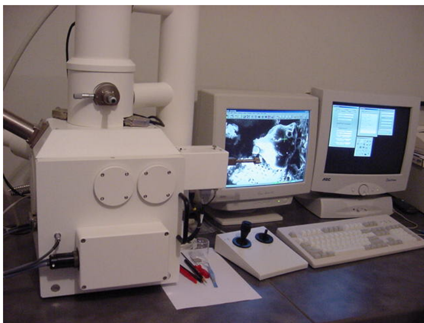
FIGURA 57 – Microscópio Eletrônico de Varredura (MEV). Fonte: Museu Emílio Goeldi.
