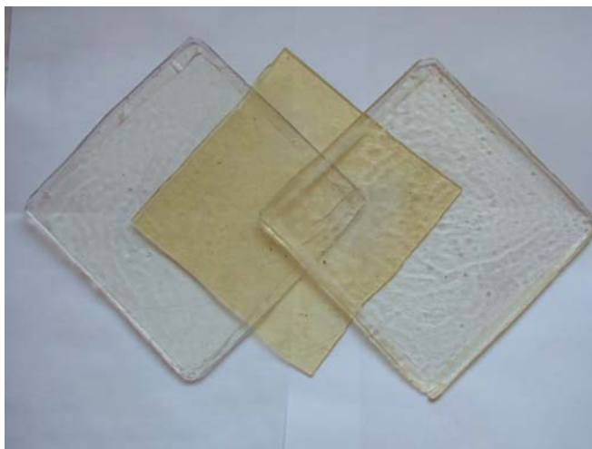
FIGURA 76 – As três lâminas de 2mm para constituir a placa de matriz híbrida: a do meio é de poliuretana e as duas externas são de poliéster.
