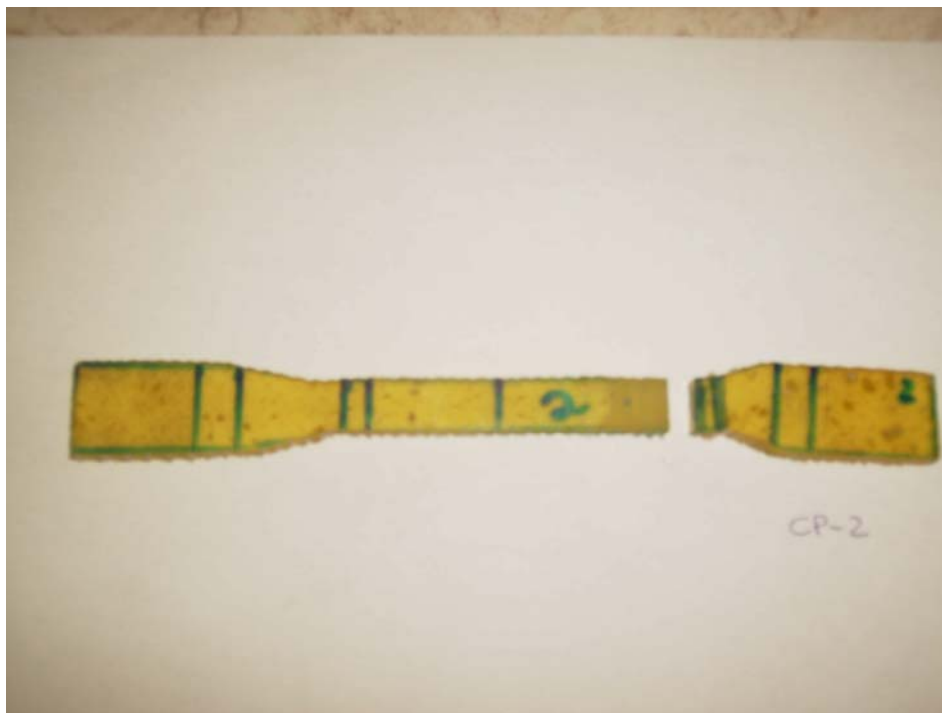
FIGURA 81 – Corpo de prova n°2 da matriz de poliuretana após ensaio de tração: partiu em duas partes separadas no limite do extensômetro.
