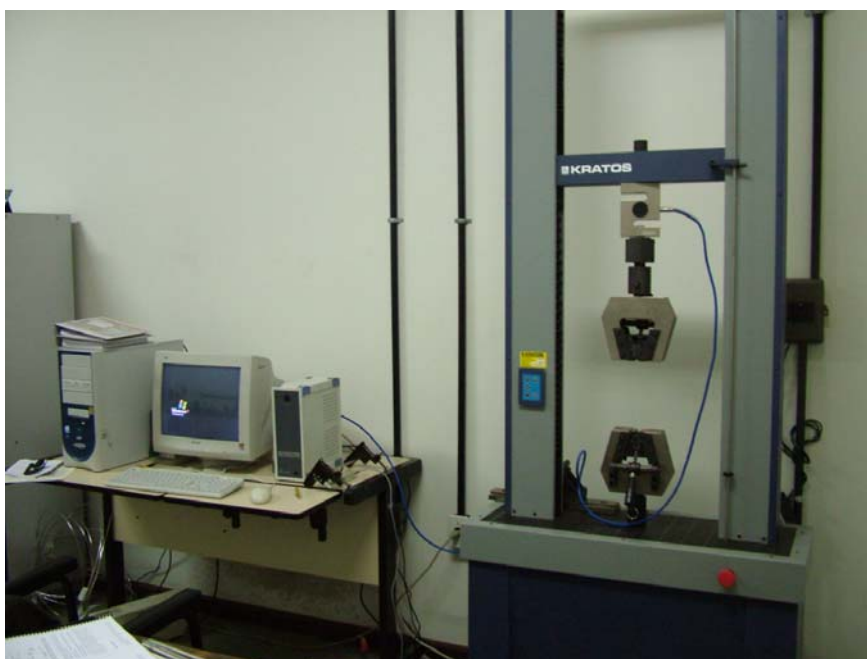
FIGURA 56 – Máquina de ensaio universal KRATOS, modelo KE 3000MP, capacidade 3000Kgf com software aplicativo.
