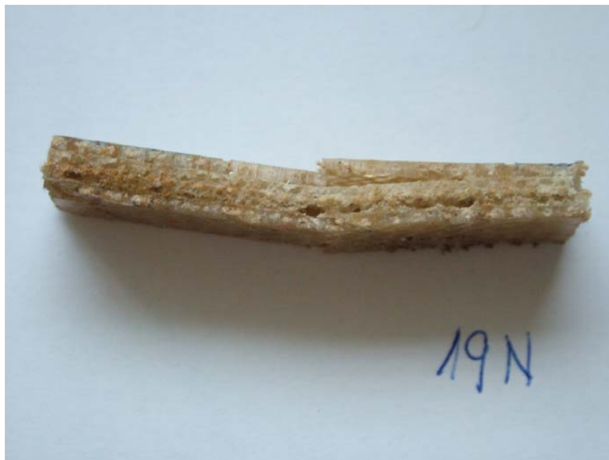
FIGURA 108 – Corpo de prova nº19 do compósito após ensaio de impacto Charpy normal ao plano do laminado: as lâminas externas de poliéster e juta foram rompidas e a interna de poliuretana e juta permaneceu intacta.
