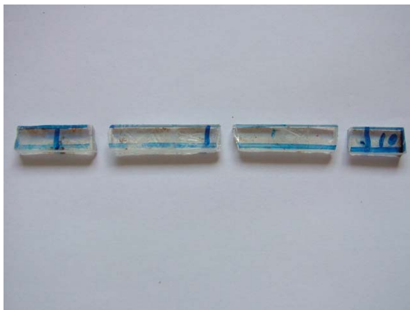
FIGURA 99 – Corpo de prova nº10 da matriz de poliéster após ensaio de flexão: quebra no meio e nos apoios, caracterizando um material frágil.
