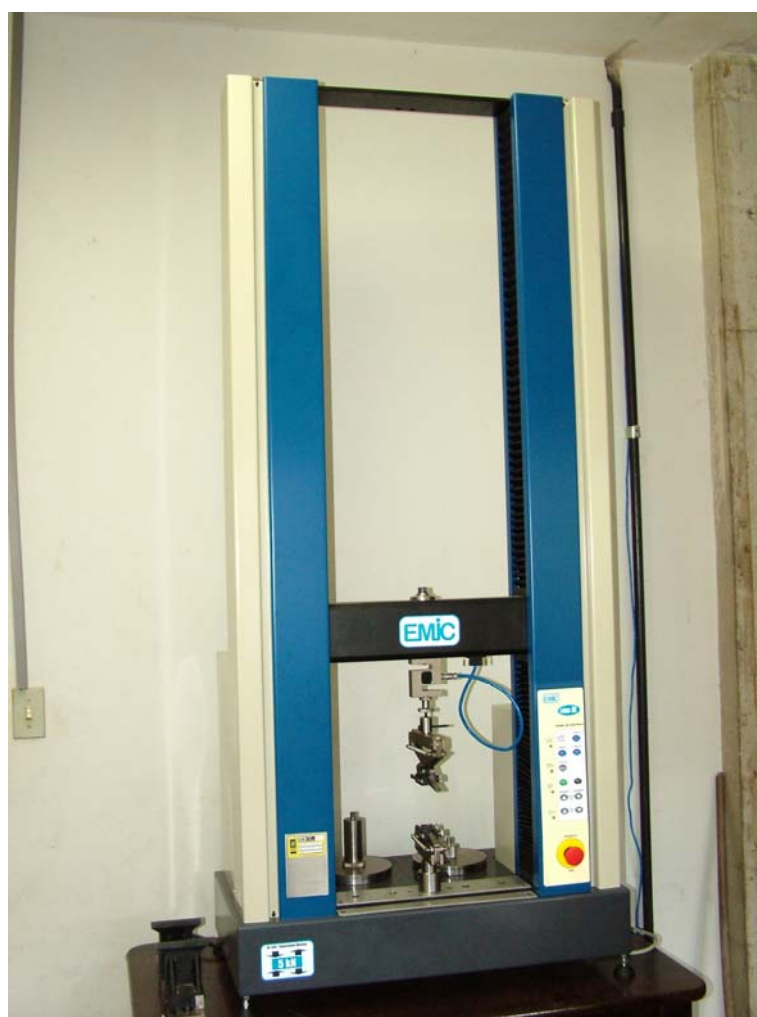
FIGURA 51 – Máquina de ensaio universal EMIC.
