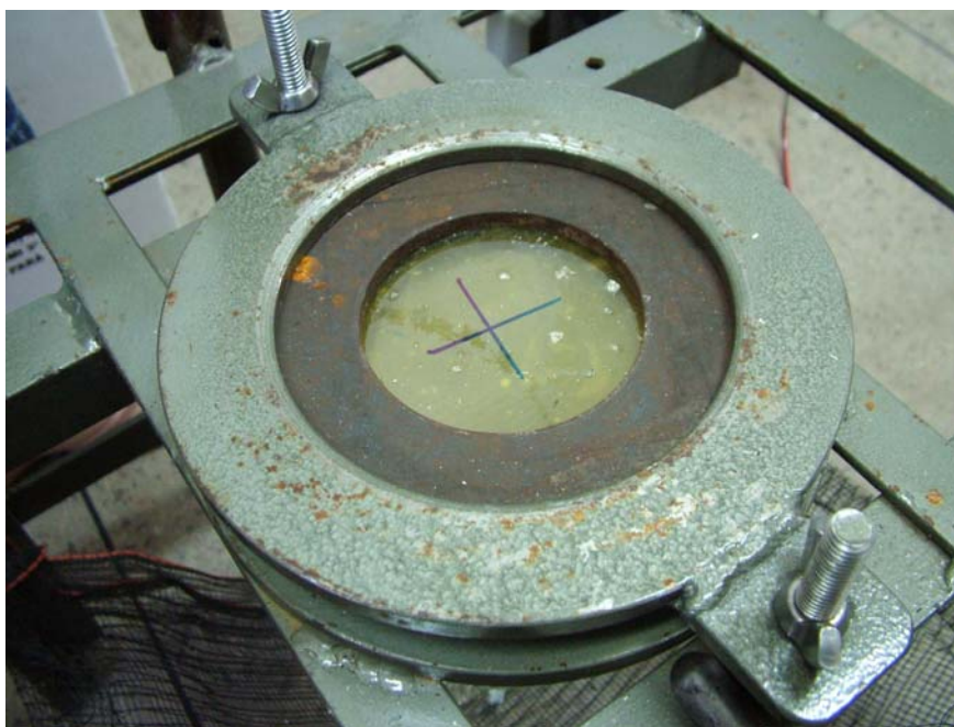
FIGURA 111 – Corpo de prova de poliuretana ensaiado: nenhuma falha e nem deformação permanente até a massa de 0,90kg.
