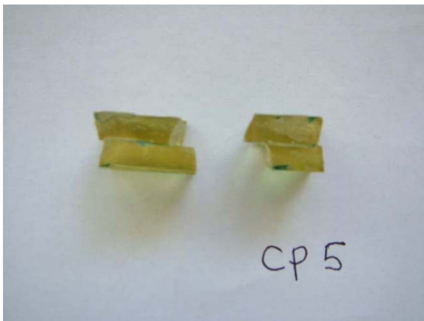
FIGURA 92 - Corpo de prova n° 5 da matriz de poliuretana após ensaio de compressão: o corpo de prova não descolou, porém, partiu ao meio na sua dimensão paralela à força aplicada.
