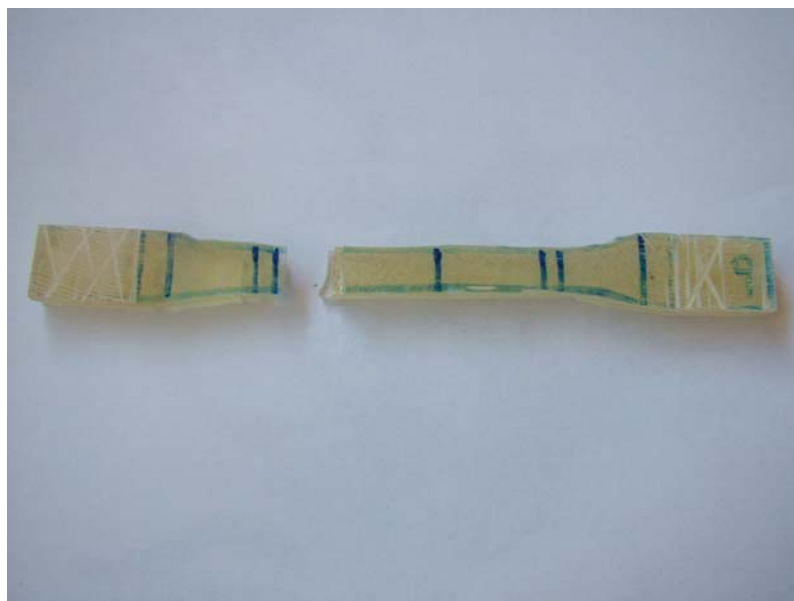
FIGURA 83 – Corpo de prova n°9 da matriz híbrida após ensaio de tração: partiu em duas partes separadas no limite do extensômetro. As ranhuras nas extremidades foram feitas para melhorar a aderência para a garra não escorregar.
