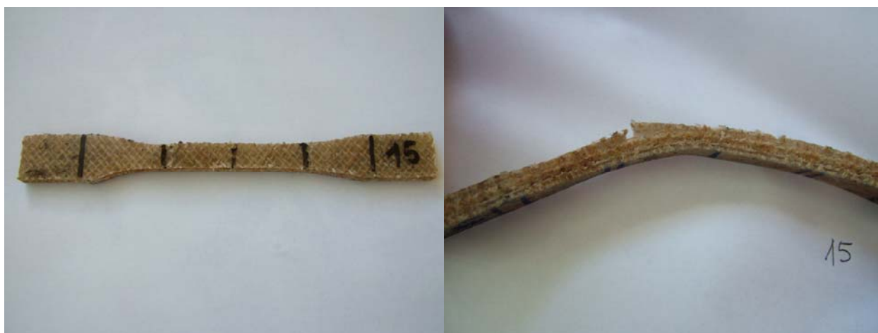
FIGURA 88 – Corpo de prova n°15 do compósito após ensaio de tração: em (a) uma das lâminas externas e a interna não romperam e em (b) o rompimento de uma das lâminas externas de poliéster e juta.
