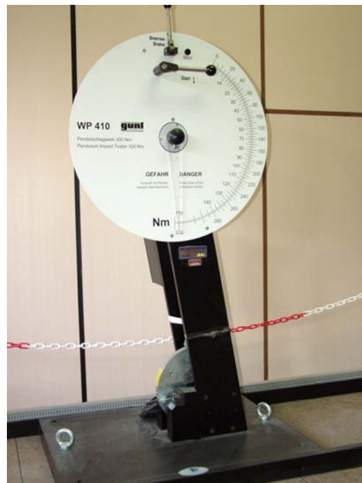
FIGURA 53 – Equipamento para o ensaio de impacto Charpy.
