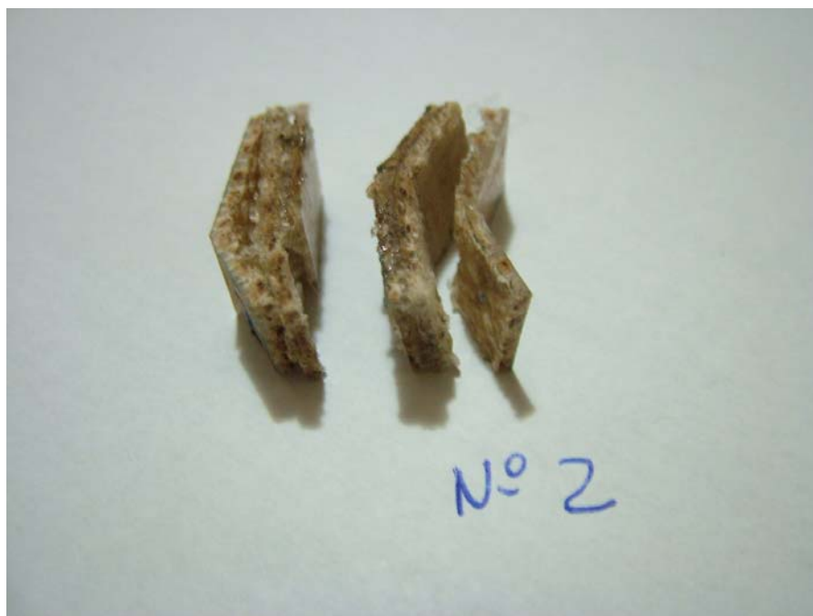
FIGURA 96 – Corpo de prova nº 2 do compósito após o ensaio de compressão: delaminações, rompimentos das lâminas de poliéster e juta e as lâminas de poliuretano e juta intactas.
