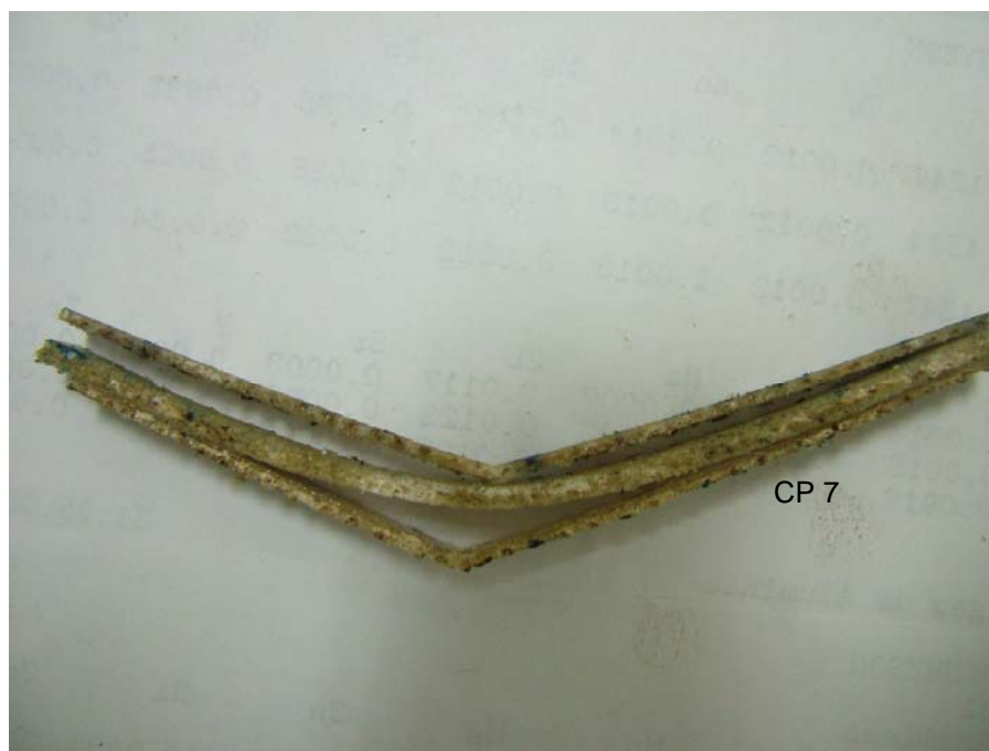
FIGURA 102 – Corpo de prova n° 7 do compósito após ensaio de flexão: delaminação total.
