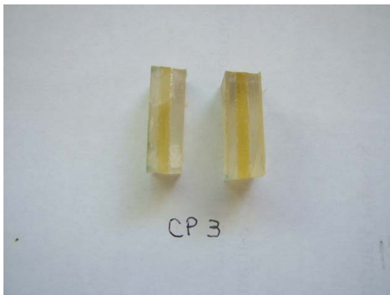
FIGURA 94 - Corpo de prova n° 3 da matriz híbrida após ensaio de compressão: o corpo de prova foi separado em duas partes somente, na cola de poliuretano.
