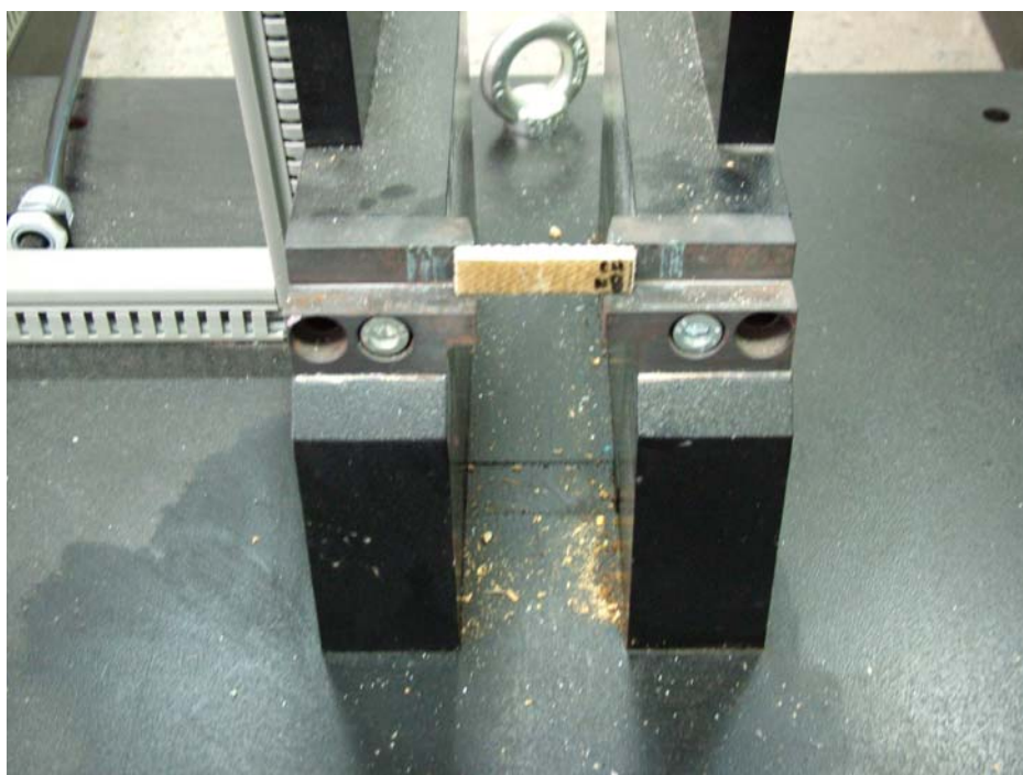
FIGURA 106 – Corpo de prova do compósito sendo submetido ao ensaio de impacto Charpy normal ao plano do laminado.
