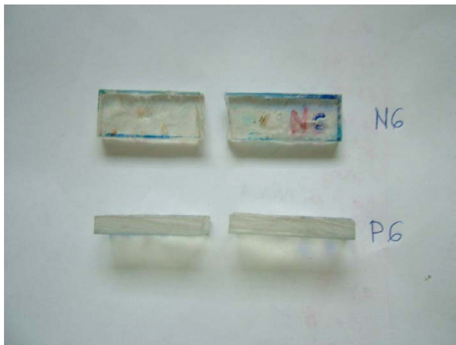
FIGURA 104 – Corpo de prova nº6 (normal e paralelo) após ensaio de impacto Charpy: quebraram em duas partes e os resultados normais e paralelos foram quase iguais quanto a energia absorvida e quanto a resistência ao impacto.
