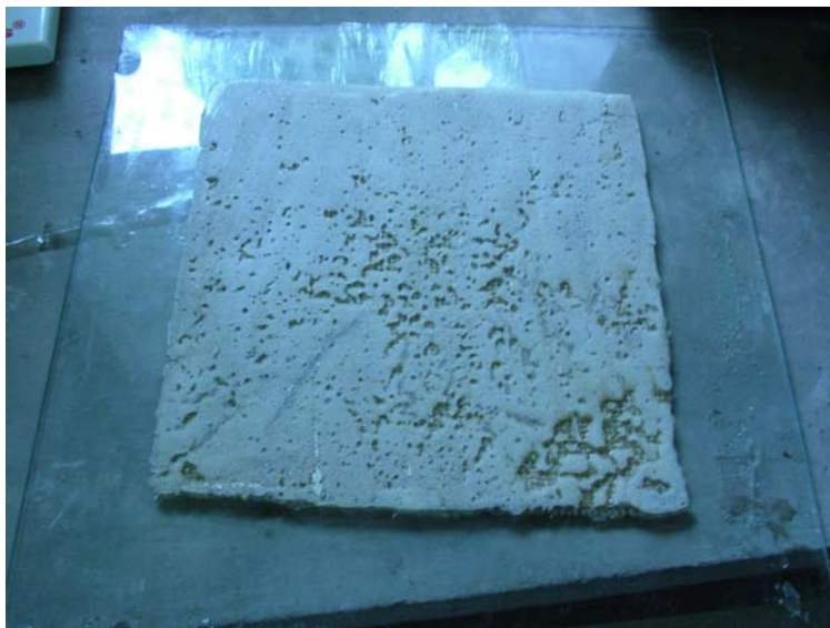
FIGURA 68 – Lâmina de tecido de juta a 90° com a resina de óleo de mamona.
