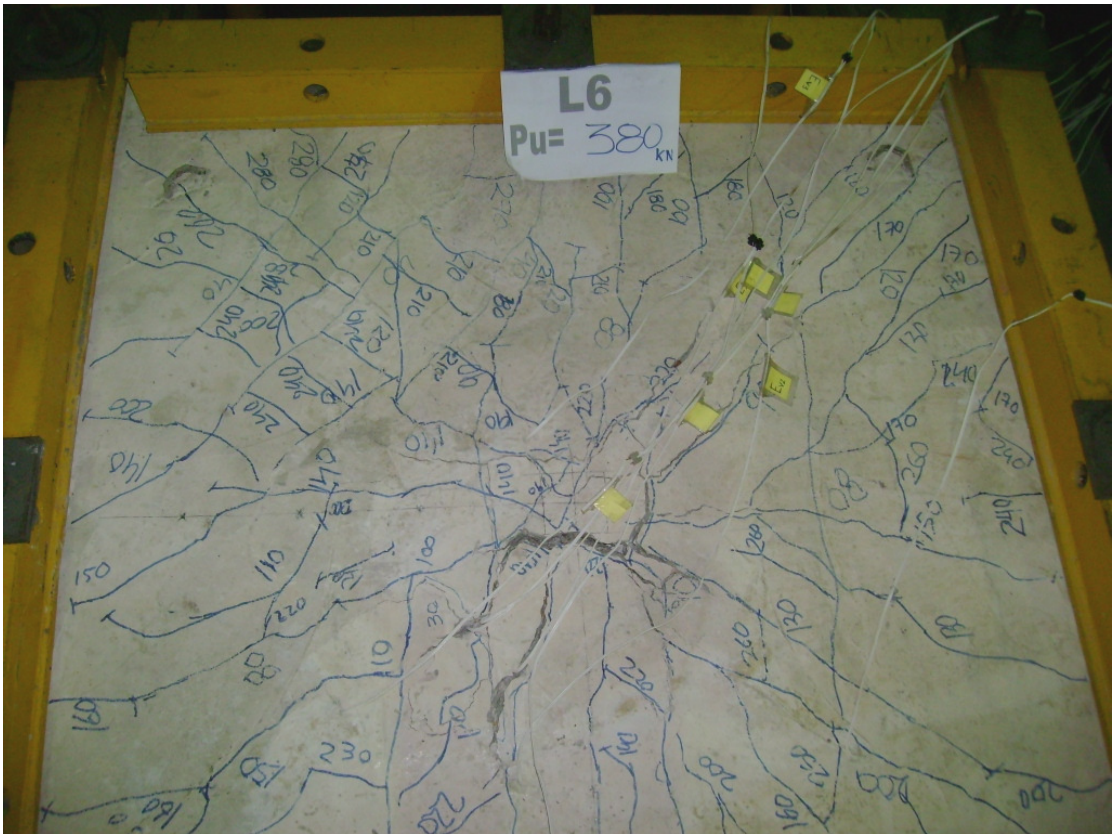
Figura 135 - Padrão de fissuração da laje L6
