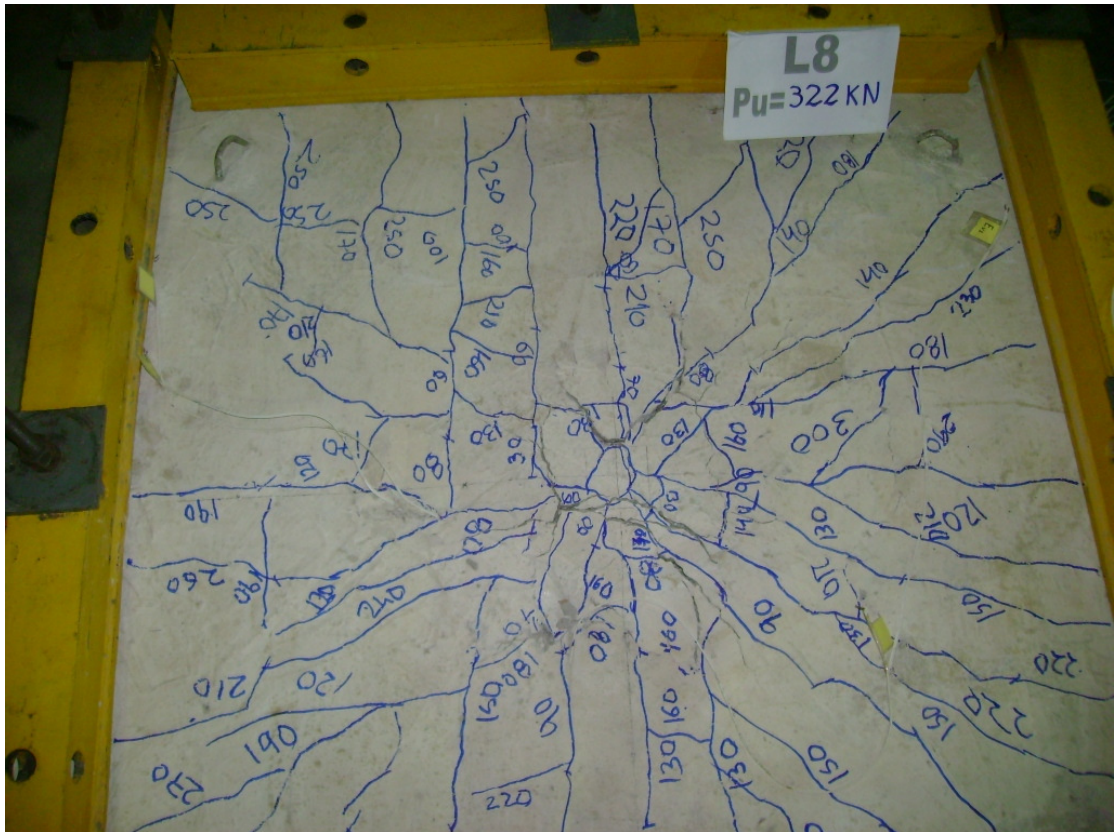
Figura 137 - Padrão de fissuração da laje L8
