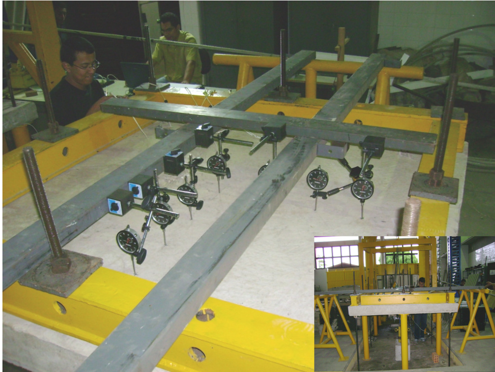
Figura 52 - Detalhe do posicionamento dos deflectômetros na laje
