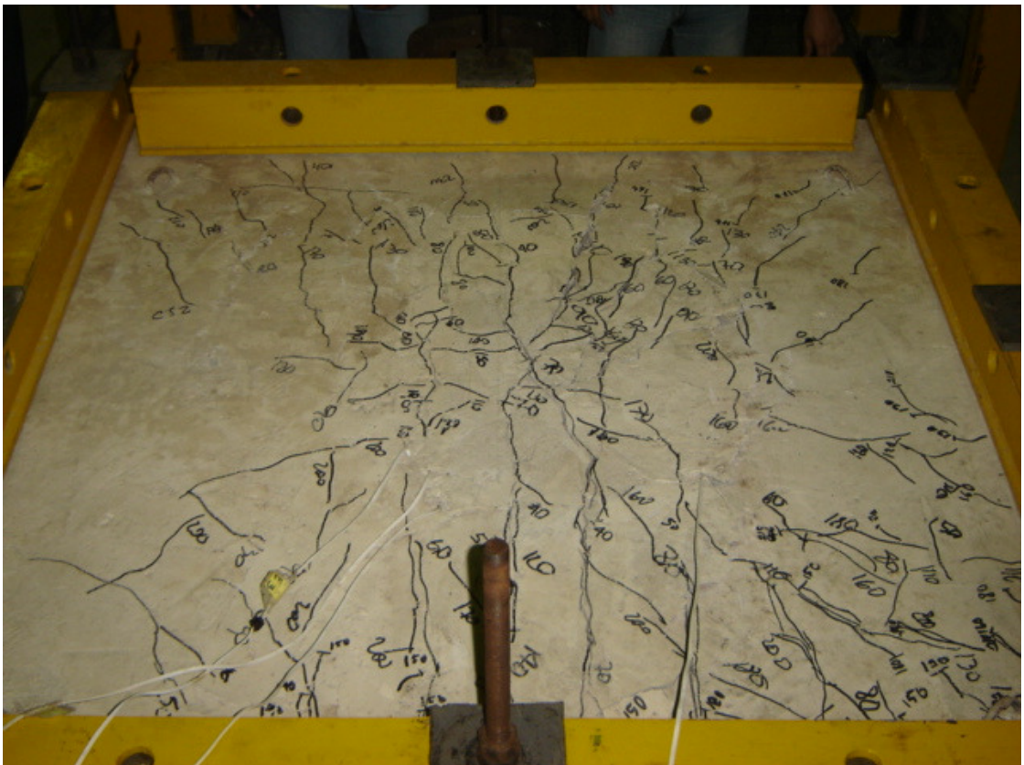
Figura 130 - Padrão de fissuração da laje L1
