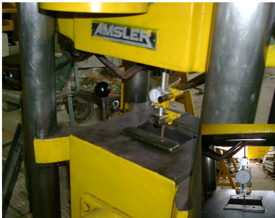
Figura 81 - Ensaio de tração do aço
