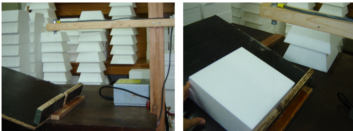
Figura 34 - Cortador de EPS tipo fio quente
