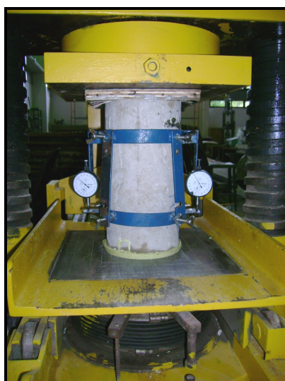
Figura 80 - Ensaio de módulo de elasticidade do concreto
