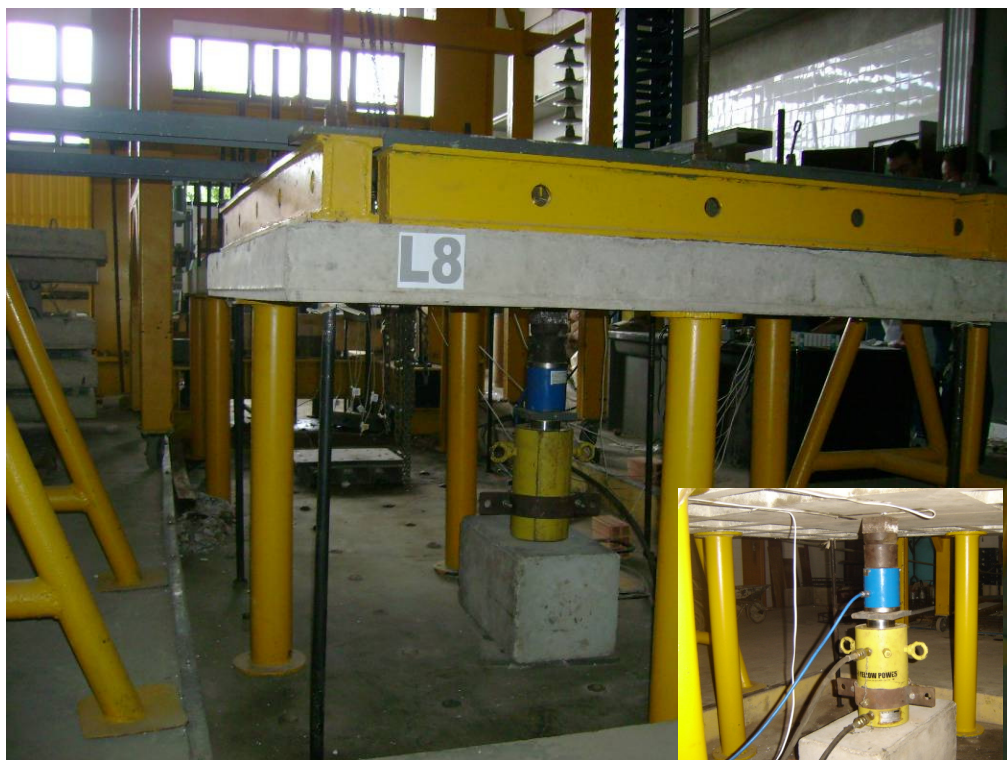
Figura 77 - Dispositivo de aplicação de carga
