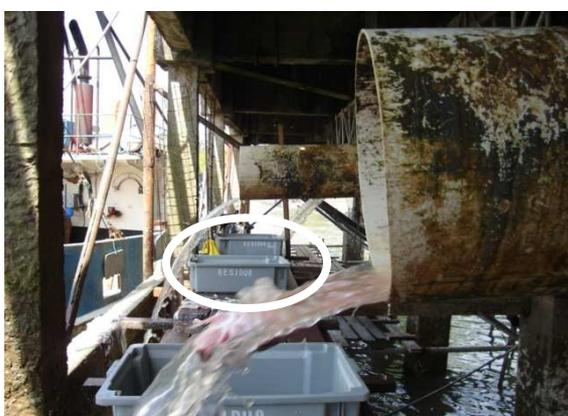
Figura 12 - Medição de vazão com basqueta.
