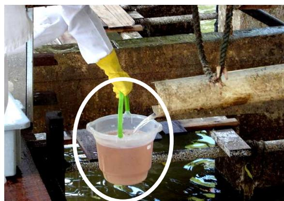
Figura 13 - Medição de vazão com balde.
