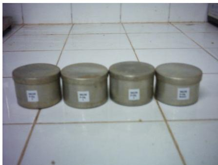
Figura 27 – Reatores utilizados nos ensaios de reatividade pelo método químico, sendo um deles destinado ao ensaio em branco (referência).
