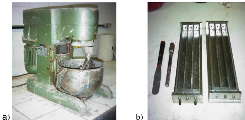
Figura 25 – (a) Argamassadeira utilizada no processo de confecção da argamassa; (b) Moldes metálicos utilizados para confecção dos corpos-de-prova.
