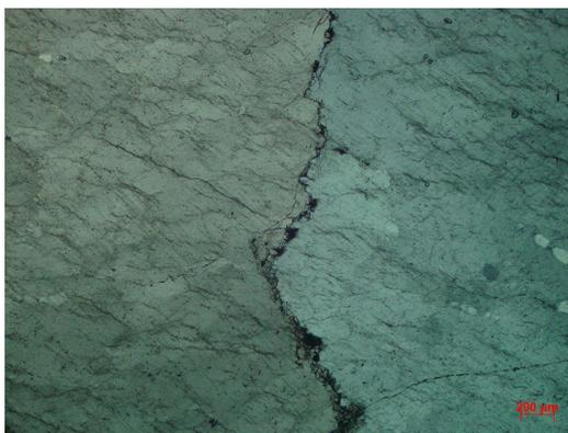
Figura 43 – Fissuras orientadas presentes na superfície do seixo da jazida M.G.M.
