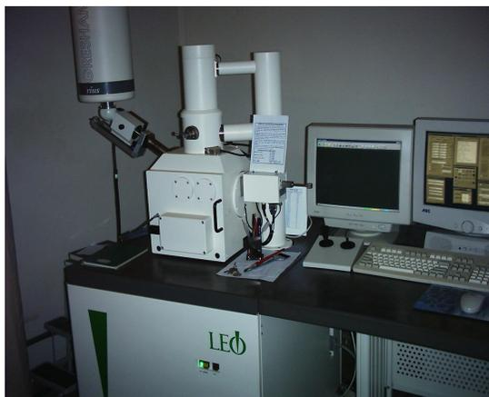
Figura 30 – Microscópio eletrônico de varredura utilizado na análise microscópica.
