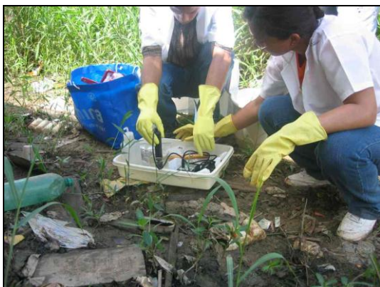
Fotografia 23 – Medição de oxigênio dissolvido na água do igarapé Mata Fome. Fonte: Direta (2006)
