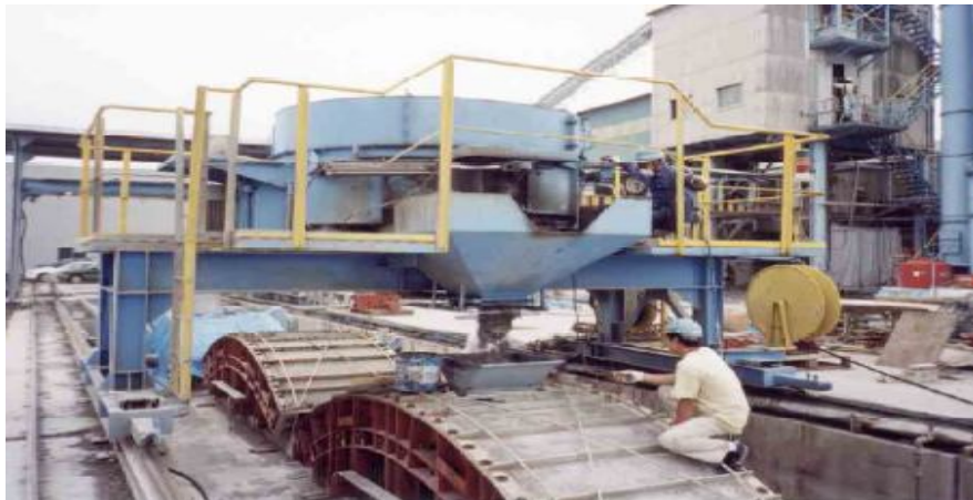
Figura 2.4 – Concretagem dos segmentos pré-moldados do túnel de Yokohama no Japão (1994). Fonte: Takeshi et al. (1994).
