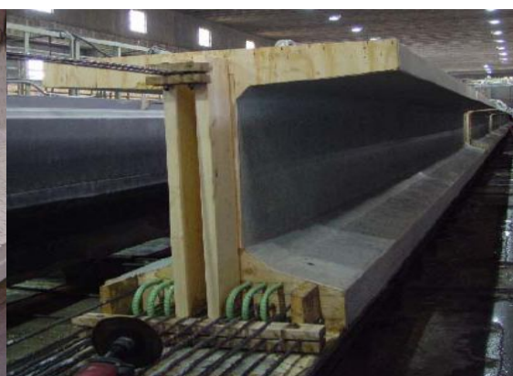
Figura 2.5 – (a) Aspecto do CAA no estado fresco na produção de peças pré-moldadas em fábrica na Alemanha; (b) e (c) detalhe do acabamento superficial de peças concretadas com o CAA. Fonte: EFNARC (2005).
