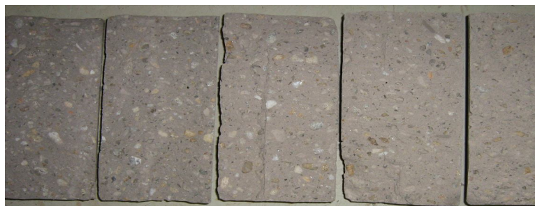
Figura 4.15 – Distribuição uniforme dos agregados graúdos no CAA 03 (traços 1:2, 1:3, 1:4, 1:5 e 1:6 da esquerda para a direita).
