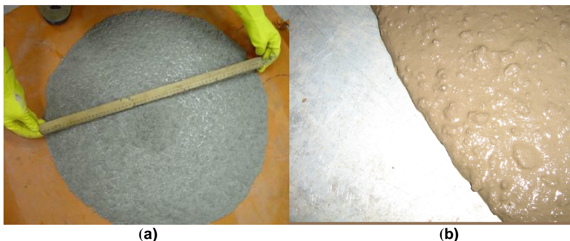
Figura 2.22 - a) Mistura fluindo adequadamente em todas as direções; b) mistura sem segregação entre o agregado graúdo e a argamassa.
