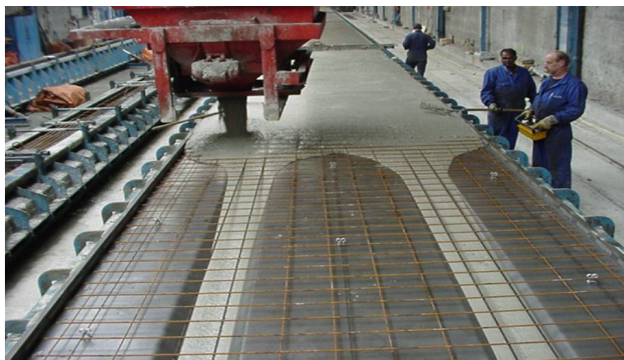
Figura 2.4 – Concretagem dos segmentos pré-moldados do túnel de Yokohama no Japão (1994). Fonte: Takeshi et al. (1994).
