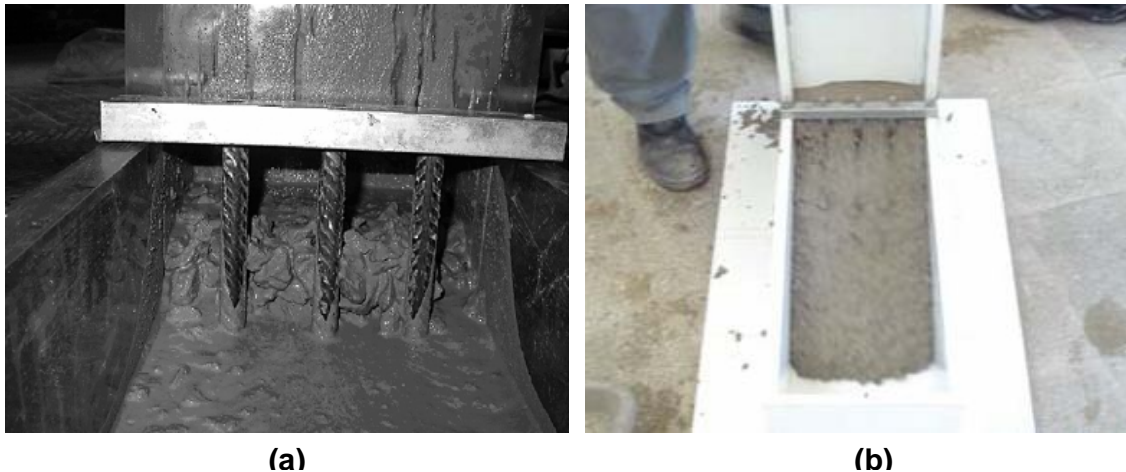
Figura 2.26 - a) Obstrução do fluxo pelo acúmulo de agregados graúdos; b) traços na superfície do concreto.
