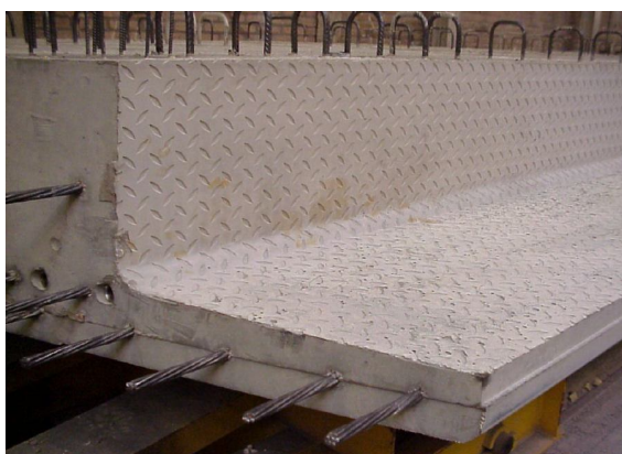
Figura 2.5 – (a) Aspecto do CAA no estado fresco na produção de peças pré-moldadas em fábrica na Alemanha; (b) e (c) detalhe do acabamento superficial de peças concretadas com o CAA. Fonte: EFNARC (2005).
