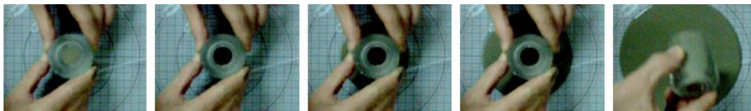
Figura 2.43 - Ensaio do mini-slump sendo realizado em argamassa. Fonte: Calmon (2006).
