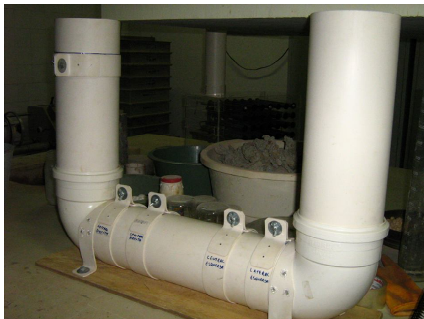
Figura 2.30 - Detalhe do tubo em U pronto para receber a mistura de concreto.
