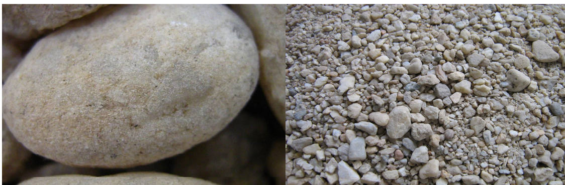
Figura 2.33 – Forma arredondada e granulometria contínua são características do seixo rolado da região de Belém-Pa.
