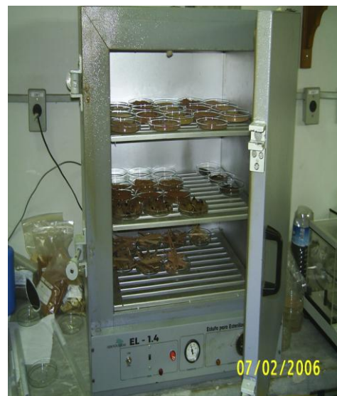
Fotografia 25: Estufa para esterilização e secagem da biomassa em questão.
