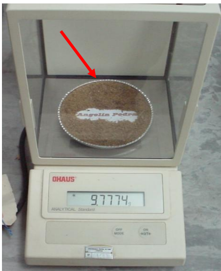
Fotografia 24: Prato de alumínio de massa conhecida e balança analítica para se conhecer o peso da biomassa em questão.
