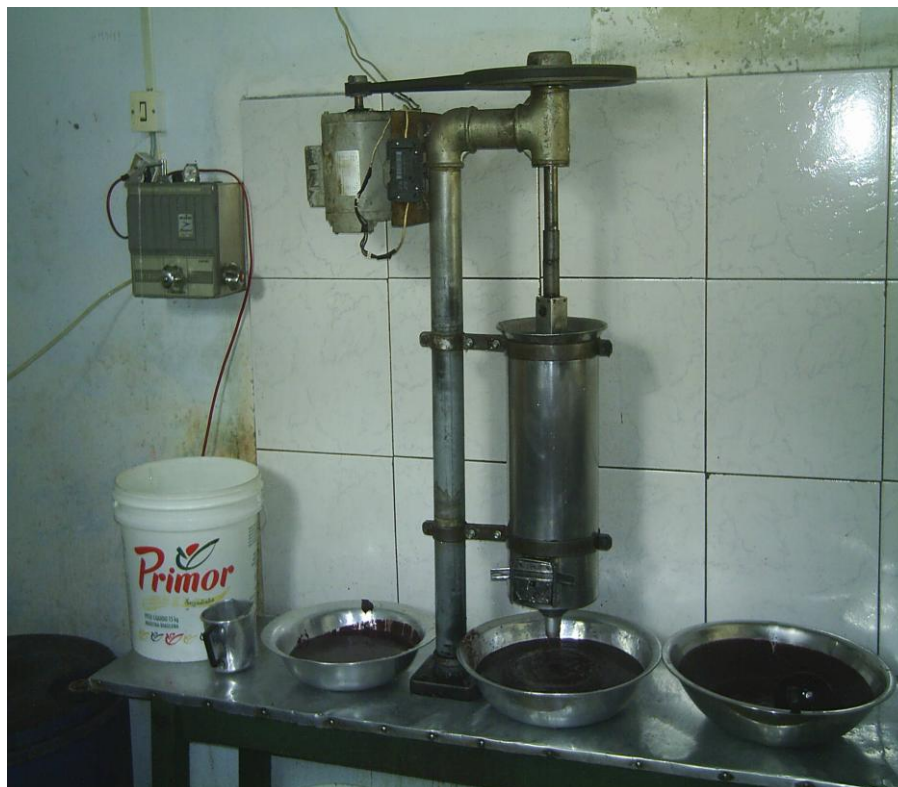
Fotografia 9: Máquina de despulpamento do fruto açai (Belém-Pará).
