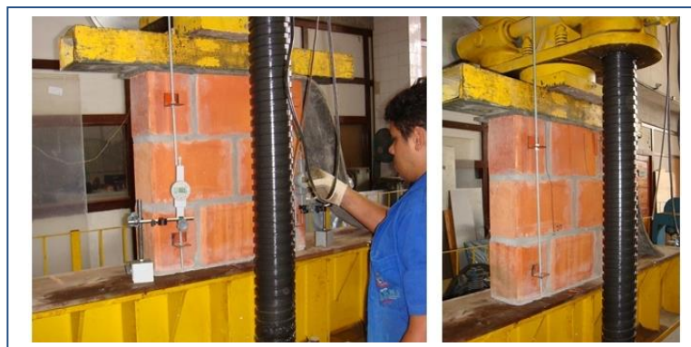
Figura 3.18 – Ensaio à compressão das mini-paredes
