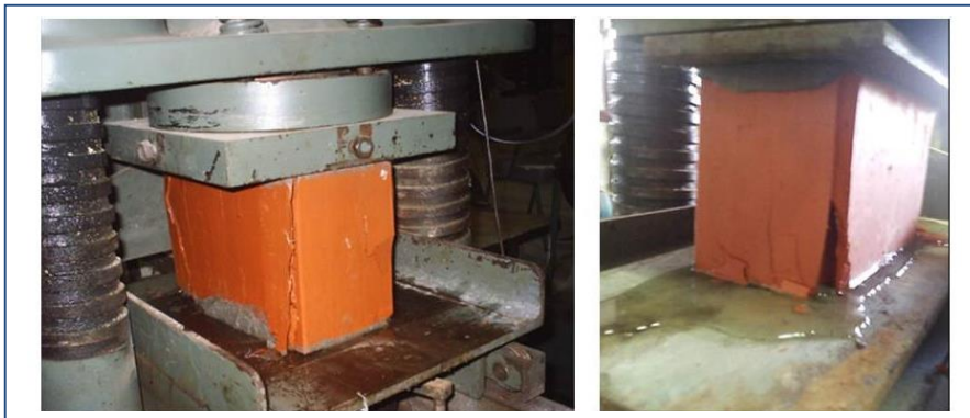
Figura 3.11 – Ensaio de compressão dos blocos
