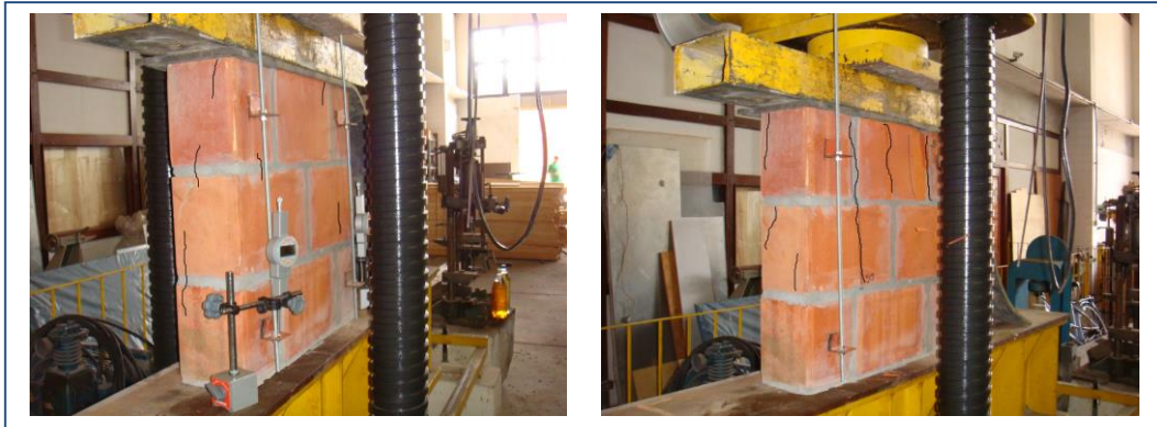
Figura 4.7 – Modo de ruptura das mini-paredes
