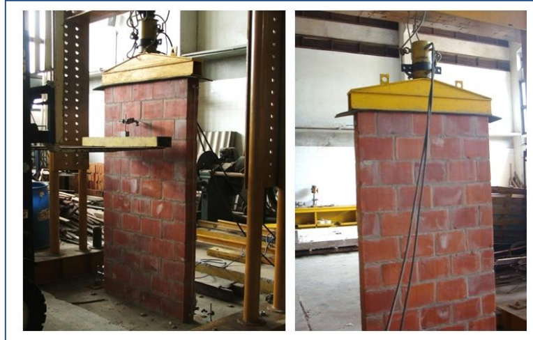
Figura 3.23 – Ensaio à compressão das paredes
