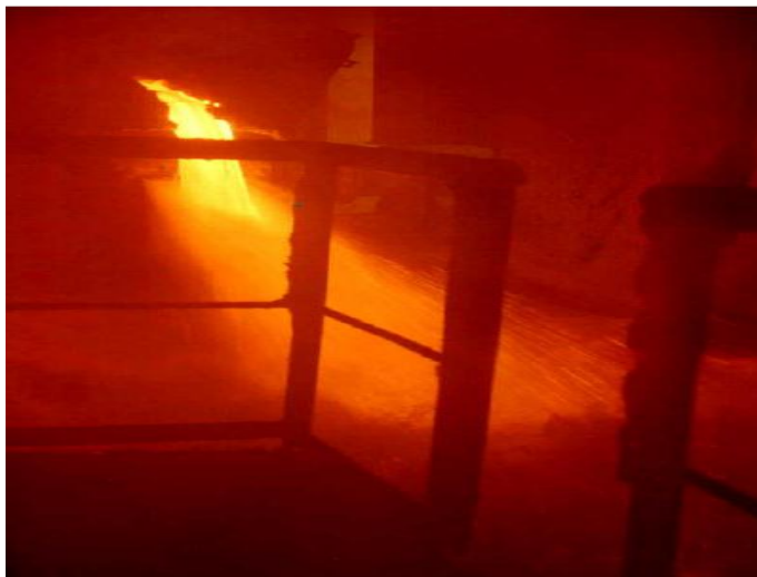
Figura 3.2- Resfriamento brusco da escória de alto-forno, por jatos d'água, na Companhia Siderúrgica de Tubarão.
