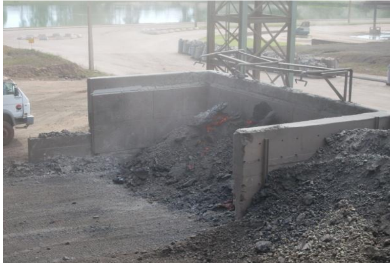
Figura 3.3- Resfriamento da escória de alto-forno ao ar livre-Siderúrgica SINOBRAS.
