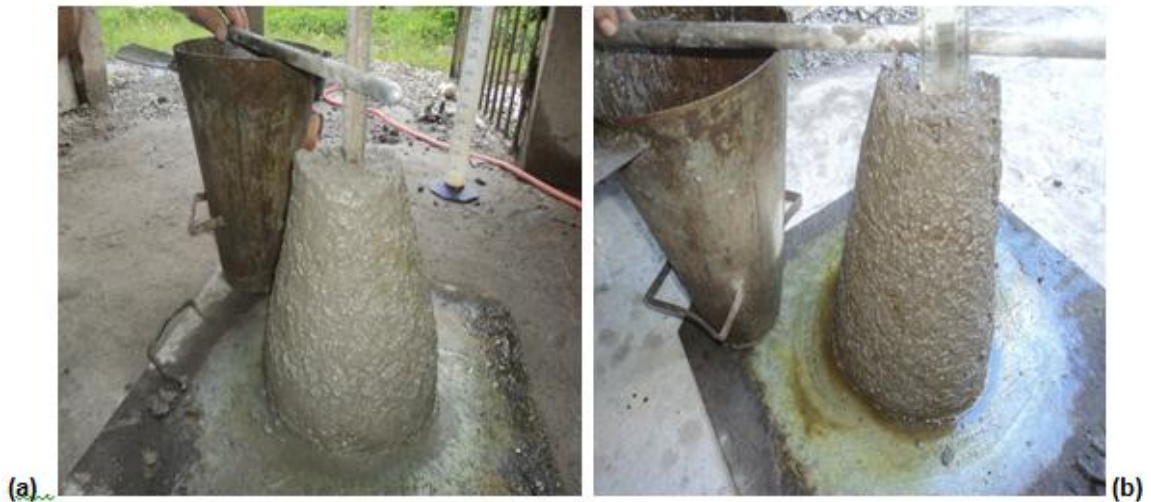
Figura 4.8- Medida do abatimento em concretos com agregados naturais e com escória. (a) concreto com agregados naturais. (b) concreto com escória.
