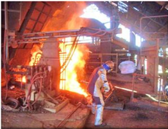
Figura 2.12 (a) e (b) – Obtenção do ferro-gusa e escória.
