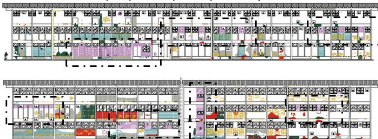
Figura 63 – Fachada B e E – ICB (Apêndice B – MD: 02/06 e MD: 05/06), com marcação nas áreas de cor lilás, as quais representam os pontos em que há intervenção indevida.
