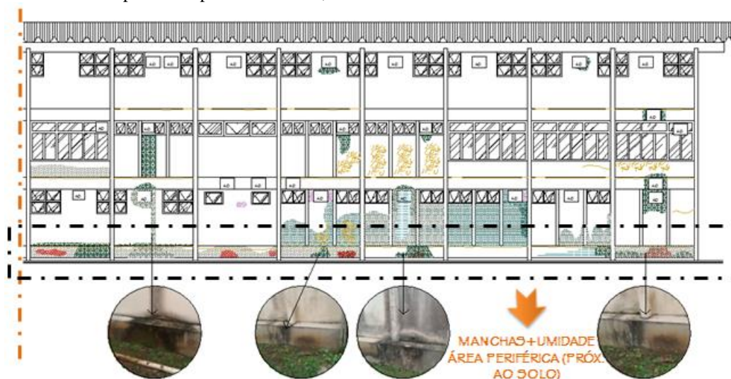
Figura 53 – Trecho da Fachada F – ICB (Apêndice B – MD: 06/06) e imagens pontuais dos danos (Novembro-Dezembro – ICB, 2013). Mapa informa a extensão dos problemas de manchas em grande parte da área periférica próxima ao solo, associada a ocorrência de umidade.
