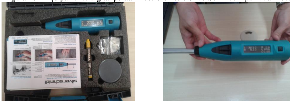
Figura 20 – Equipamento digital portátil - esclerômetro SilverSchmidt Tipo N da Proceq
