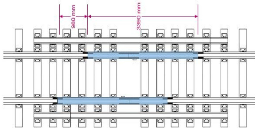
Figura 1.3 – Esquema do sistema Trainweigh desenvolvido pela Toledo do Brasil (2005)
