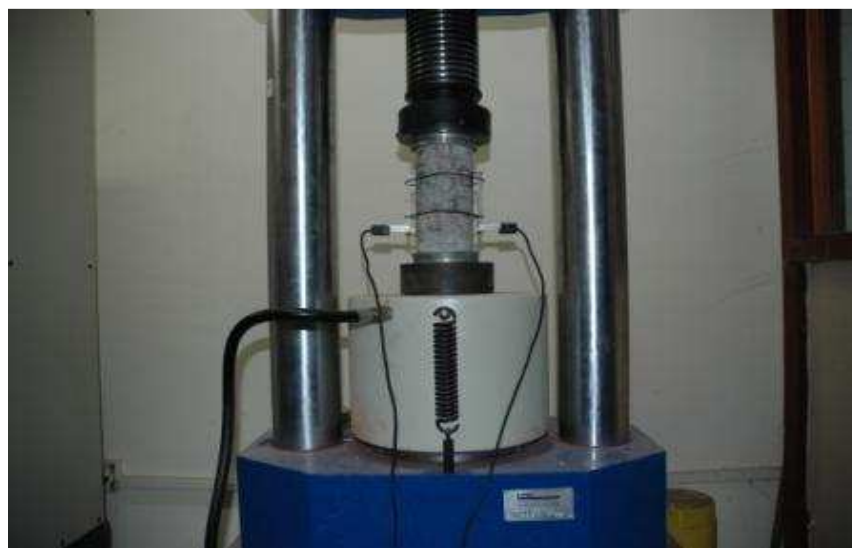
Figura 4.4– Extensômetros tipo “clip-gage” fixado no corpo-de-prova (NICAE, 2009)
