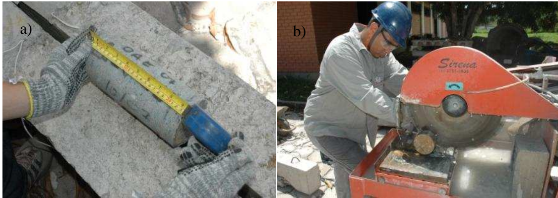
Figura 4.2 – a) Processo de marcação do testemunho para se alcançar a altura requerida de 20 centímetros. b) Corte das faces irregulares (NICAIE, 2009)
