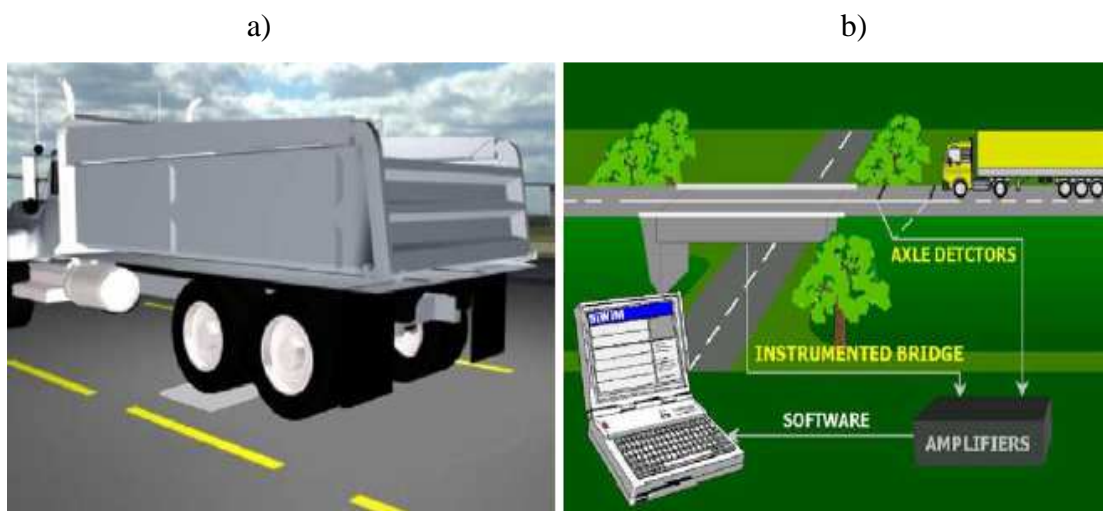
Figura 1.2 – Métodos WIM: a) Medições no pavimento, WIM; b) B-WIM, sistema como todo (Znidaric e Baumgärtner, 1998 apud Quilligan, 2003)
