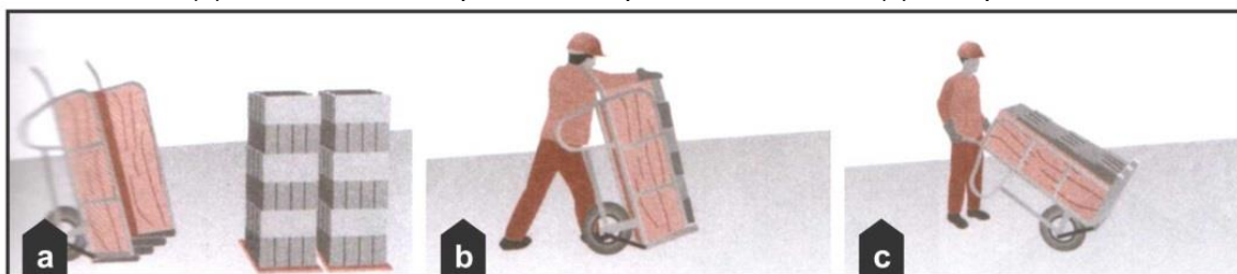
FIGURA 28 - Transporte dos blocos: (a) carrinho vazio e mini-pallet de blocos preparados; (b) encaixe dos mini-pallet nos suportes de carrinho; (c) transporte
