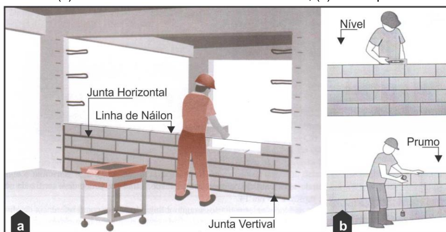
FIGURA 33 - (a) assentamento dos blocos intermediários; (b) nível e prumo das fiadas
