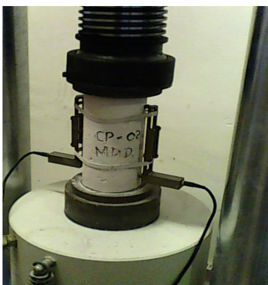
Figura 3.6 – Determinação do Módulo de Elasticidade dos concretos, na idade de 28 dias.
