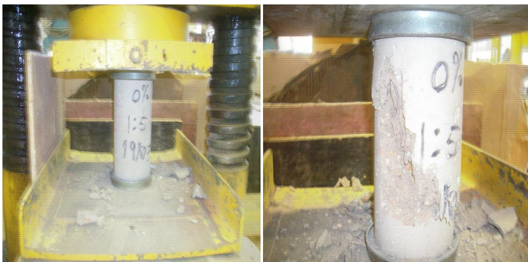
Figura 3.4 – Ensaio de compressão axial: Ruptura do corpo-de-prova.
