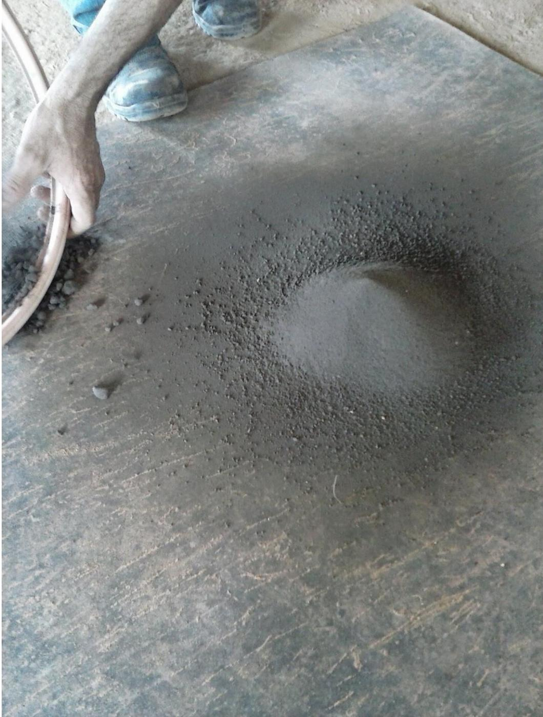
**Figura 22 Rejeito sendo peneirado.**
