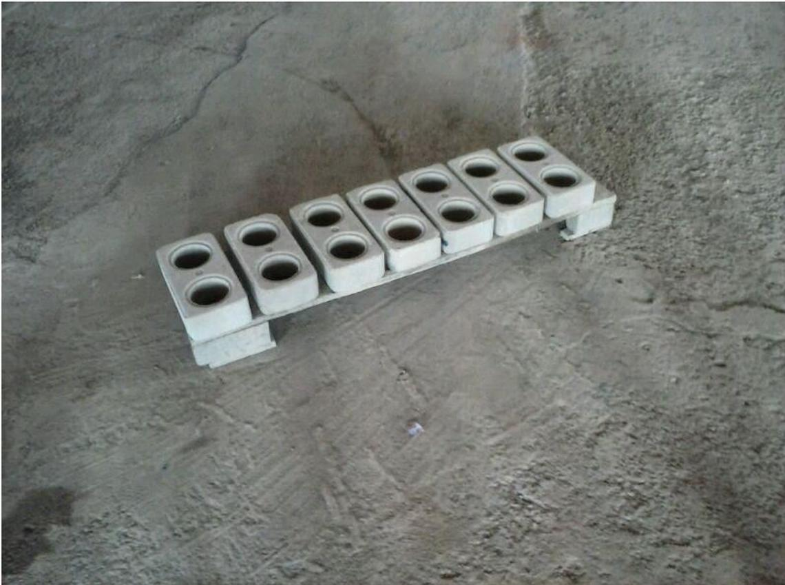
**Figura 28 Tijolos solo-cimento com rejeito mineral, após prensagem.**
