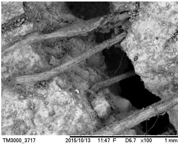
Figura 39 a-d– Microscopia do compósito após o ensaio de flexão. Fonte: Própria autora.
