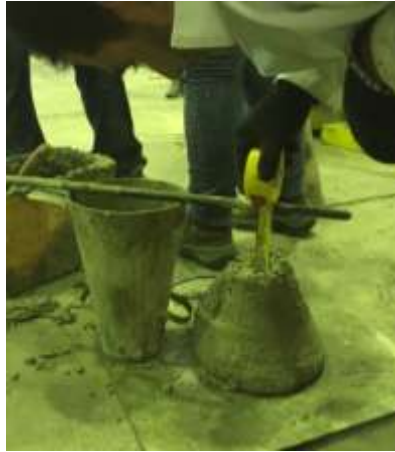
Figura 3.17 – Teste de abatimento do tronco de cone.
