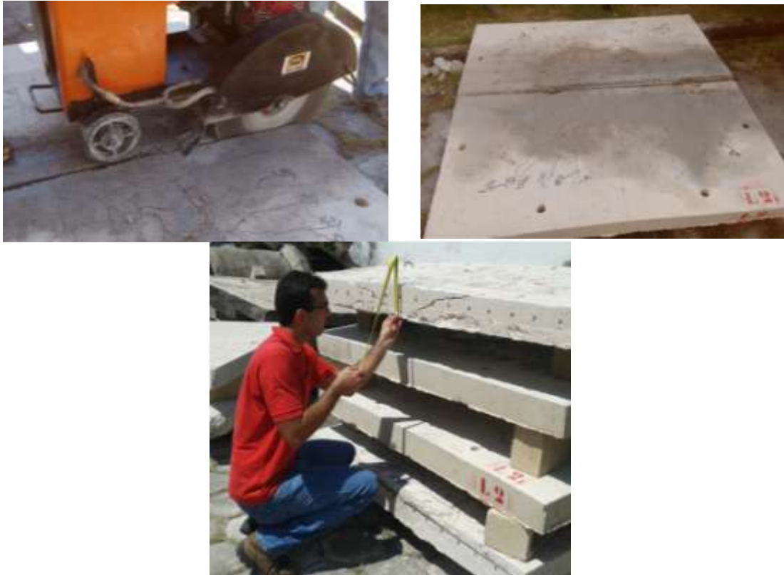
Figura 4.26 – Procedimento utilizado para realização dos cortes nas lajes e coleta da altura útil real média.
