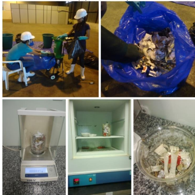
Figura 26 - (A) Trituração da amostra; (B) Amostra triturada; (C) Pesagem da amostra; (D) Amostra na Estufa e (E) Amostra após estufa.
