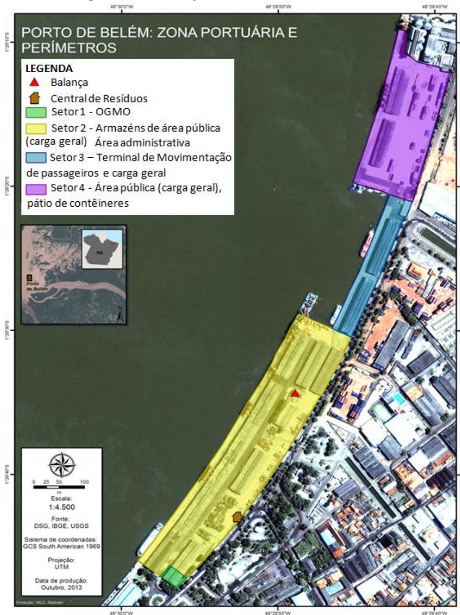
Figura 19 - Delimitação dos setores do Porto de Belém.
