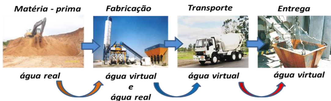
Figura 12 - Presença da água real e virtual na etapas de fabricação do concreto usinado
