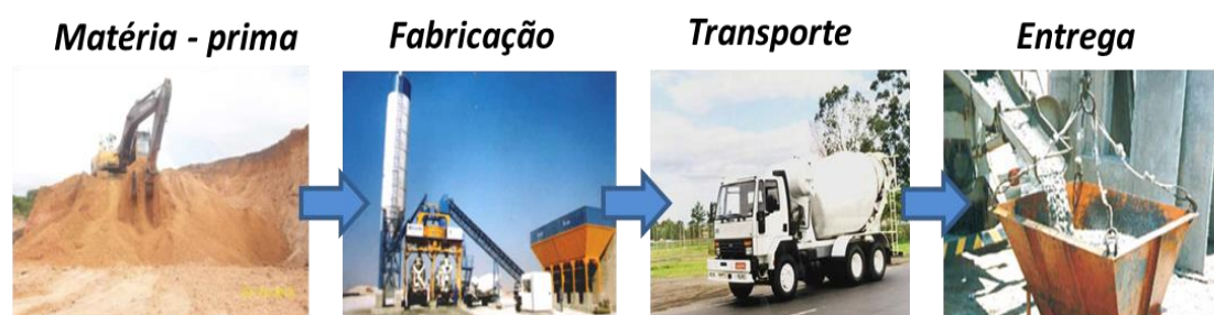
Figura 9 - Etapas da produção do concreto usinado
