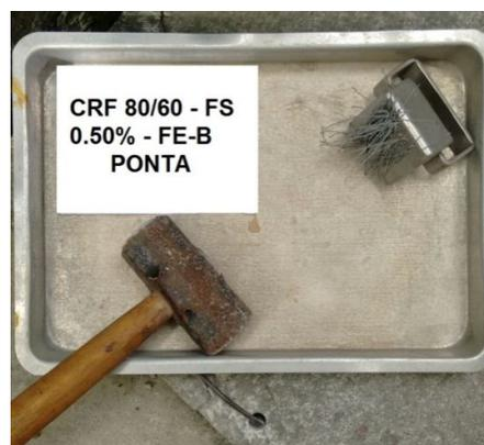
Figura 3.20 – Retirada das fibras com auxílio de imã.
