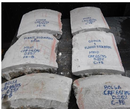
Figura 3.15 – Faixas retiradas com serra circular da parede do tubo.
