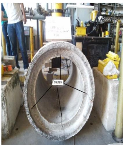
Figura 4.1 – Plano de fissuração do tubo
