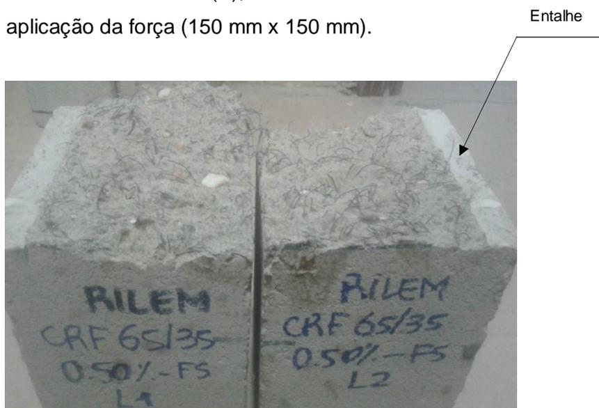
Figura 3.8 – Corpos-de-prova submetidos ao ensaio pelo RILEM
