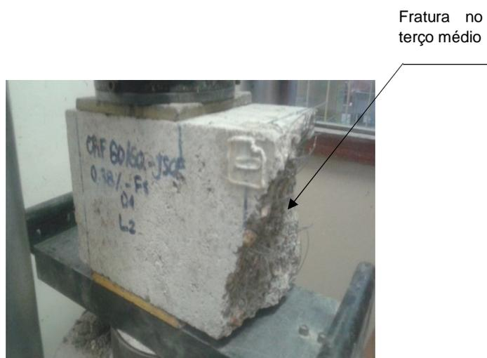
Figura 3.13 - Ensaio de compressão modificada em L<sub>2</sub> com fratura no terço médio da amostra.
