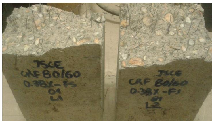
Figura 3.11 - Corpos-de-prova submetidos ao ensaio pela JSCE.
