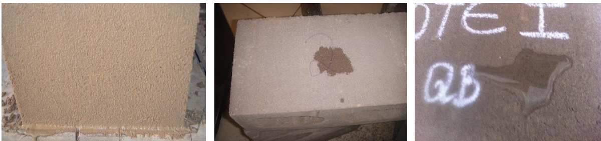
Figura 18 – (a, b, c.) aspectos visuais de indicação de teor de umidade na produção. a. b. c.
