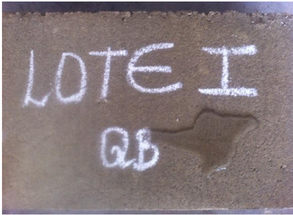
Figura 17 – Teste prático de permeabilidade – análise visual. a) teste pratico de absorção – análise visual b) impermeabilidade do bloco
