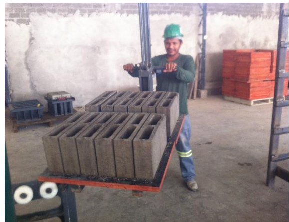
Figura 15 – Equipamento vibro-prensa hidráulico com CLP, extração através de pinça elétrica. a) maquina vibro prensa automática b) produção dos blocos, extração com pinça
