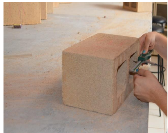
Figura 12 – Textura superficial dos blocos, Caracterização dimensional dos blocos a) textura superficial do bloco b) análise dimensional
