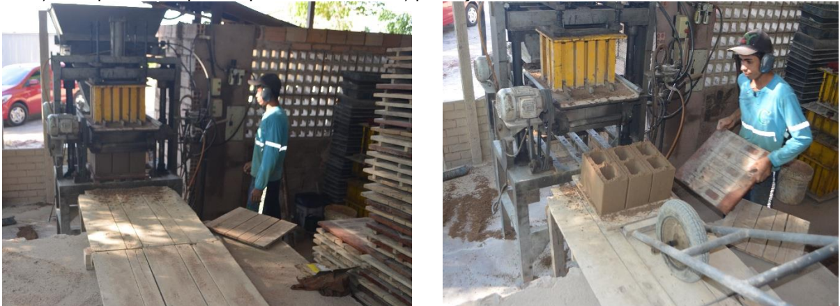
Figura 10– Vibro-prensa pneumática capacidade de produção 03 blocos por ciclo a) Máquina vibro prensa pneumática b) produção de blocos M-15, família 29
