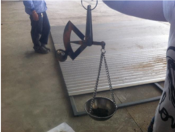
Figura 14 – Ensaio “speedy test”, para determinação da umidade da mistura. a) determinação da massa úmida B) speed test
