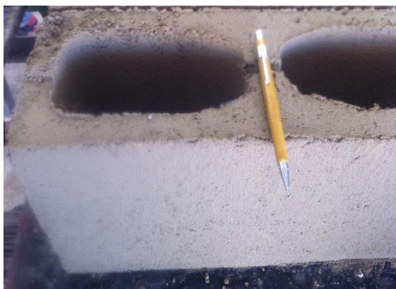
Figura 16 – Textura superficial e análise dimensional a) textura superficial do bloco b) análise dimensional
