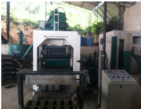
Figura 15 – Equipamento vibro-prensa hidráulico com CLP, extração através de pinça elétrica. a) maquina vibro prensa automática b) produção dos blocos, extração com pinça
