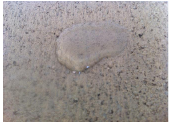
Figura 17 – Teste prático de permeabilidade – análise visual. a) teste pratico de absorção – análise visual b) impermeabilidade do bloco
