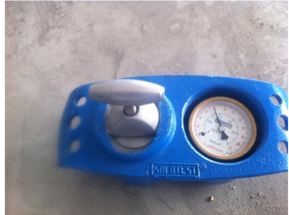
Figura 14 – Ensaio “speedy test”, para determinação da umidade da mistura. a) determinação da massa úmida B) speed test
