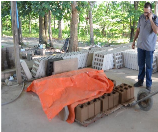
Figura 11 – Cura dos blocos sob lona no pátio de estoque; Teste de permeabilidade através do método do cachimbo.
