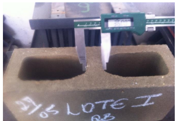
Figura 16 – Textura superficial e análise dimensional a) textura superficial do bloco b) análise dimensional
