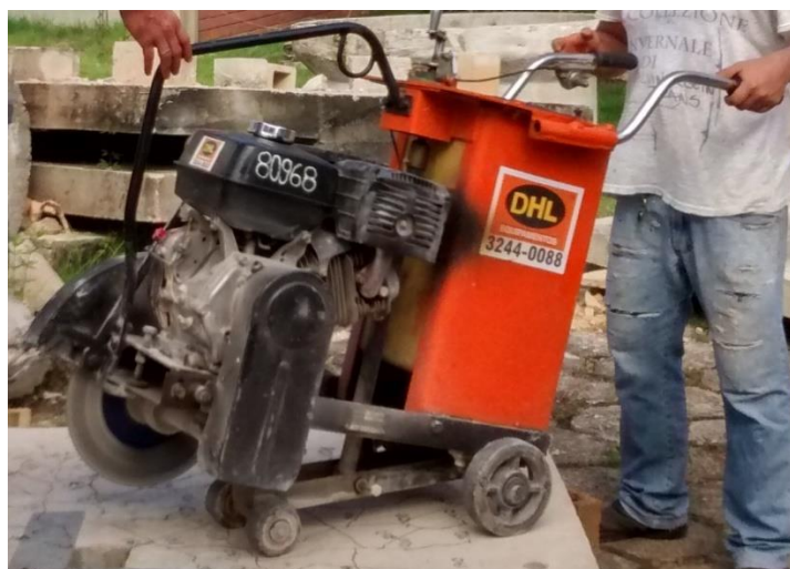
Figura 5.25 – Equipamento utilizado no corte das lajes
