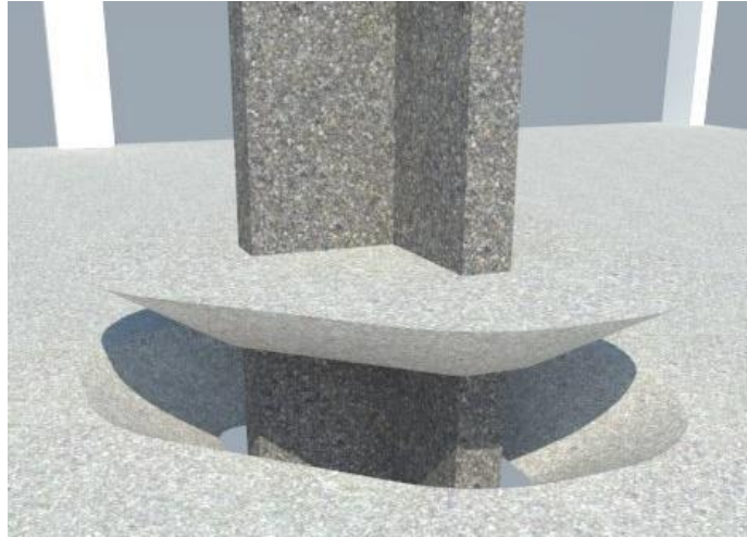
Figura 1.3 – Deslocamento vertical da laje após o puncionamento
