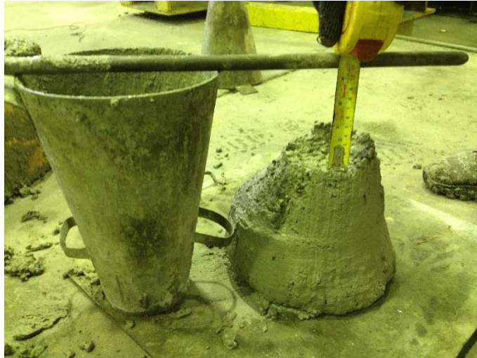
Figura 4.40 – Ensaio de abatimento do tronco de cone
