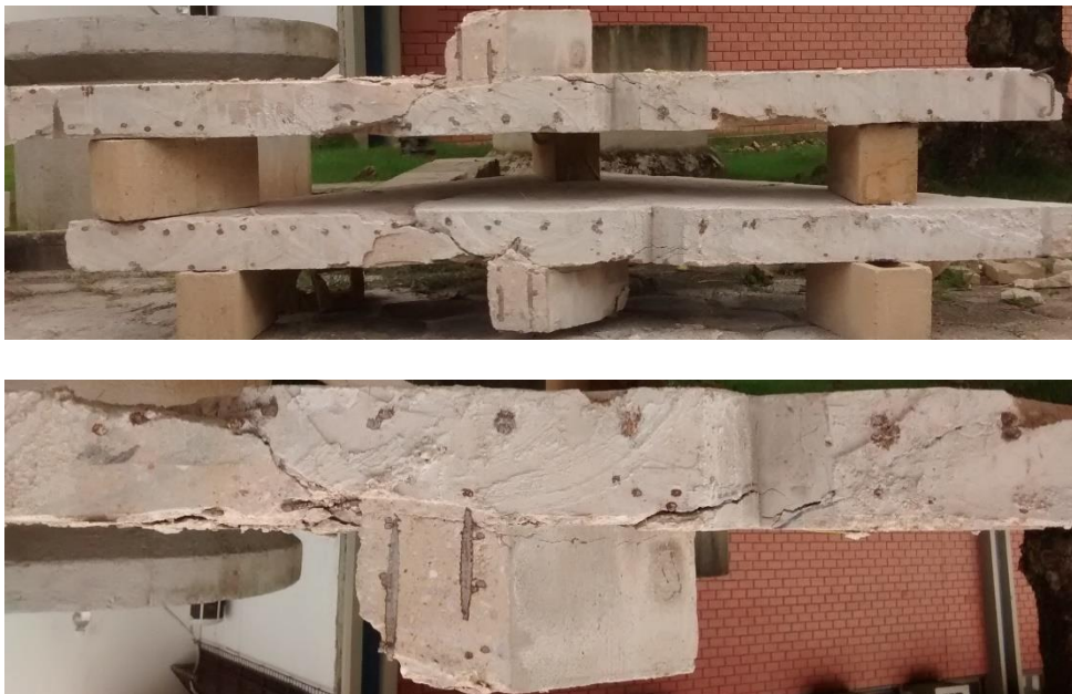
Figura 5.32 – Superfície e inclinação do cone de ruptura da laje L2
