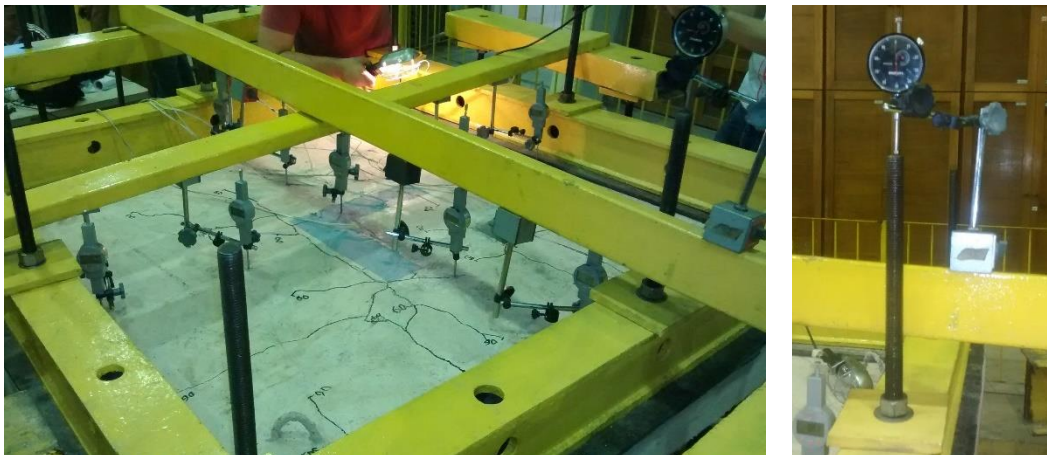
Figura 4.24 – Disposição dos deflectômetros nas lajes
