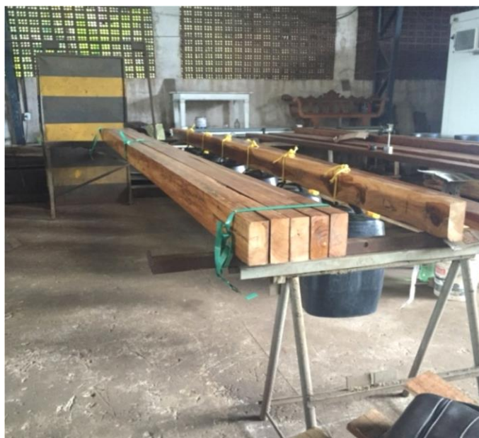
Figura 52 - Madeiras Selada com Polimento
