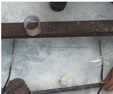
Figura 77 – Gage de 84mm no Concreto
