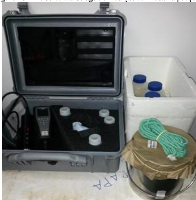
Figura 16 - Kit de coleta de água e medição utilizada na pesquisa.
