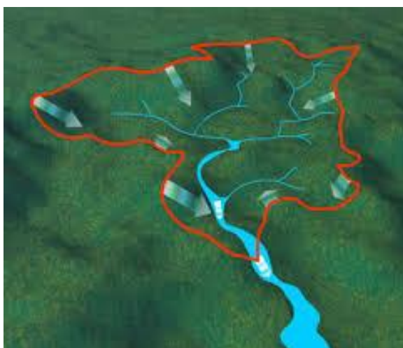
Figura 6– Modelo de uma bacia hidrográfica.
