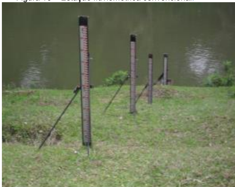
Figura 10 – Estação fluviométrica convencional.
