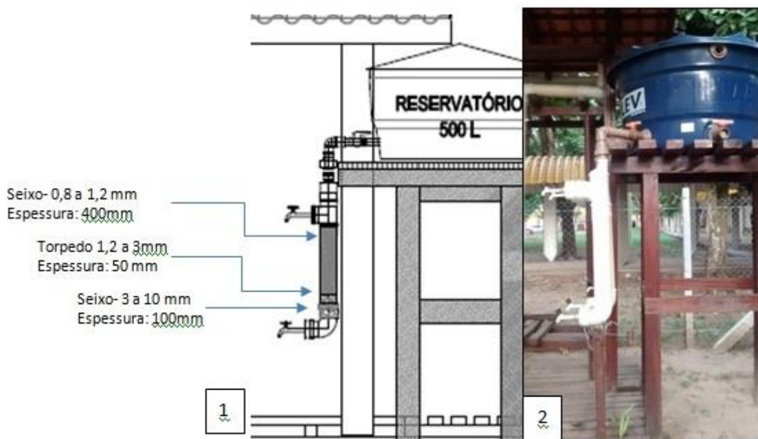
Figura 11 – Vista da UETAC com FA- 1) Perfil esquemático do FA, 2) fotografia do FA na UETAC.
