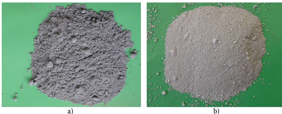
Figura 5 - Sílica ativa resultante de silício metálico proveniente de uma indústria a) da Noruega e b) do Brasil. Fonte: Dal Molin, 2011.
