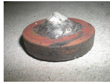
b) Ruptura do conector no 2ª ensaio de teste.
