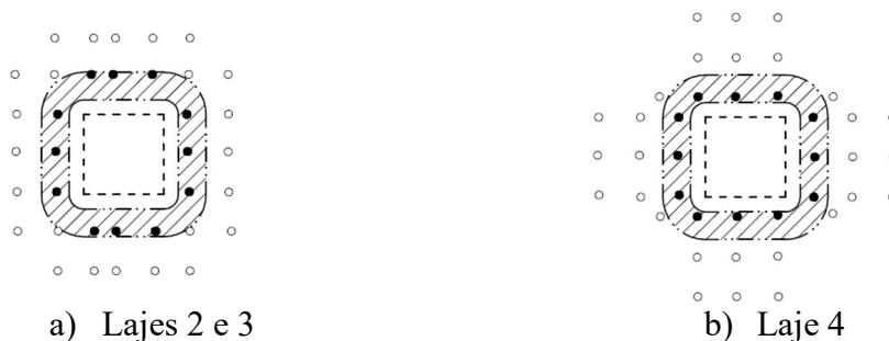
a) Lajes 2 e 3 b) Laje 4 Figura 7.24 - Lajes de REGAN (1980) – Armadura de cisalhamento considerada para o cálculo da resistência à punção de acordo com o Model Code 2010
