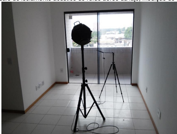
Figura 3.17 - Ensaio de isolamento acústico do ruído aéreo da laje, medição do ruído de emissão.
