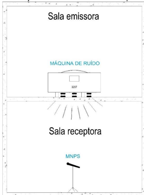
Figura 2.12 - Medição do isolamento do ruído de impacto em campo.
