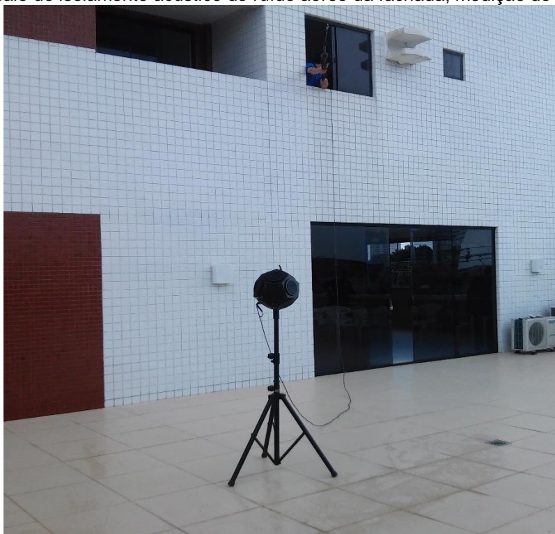
Figura 3.16 - Ensaio de isolamento acústico do ruído aéreo da fachada, medição do ruído de emissão.
