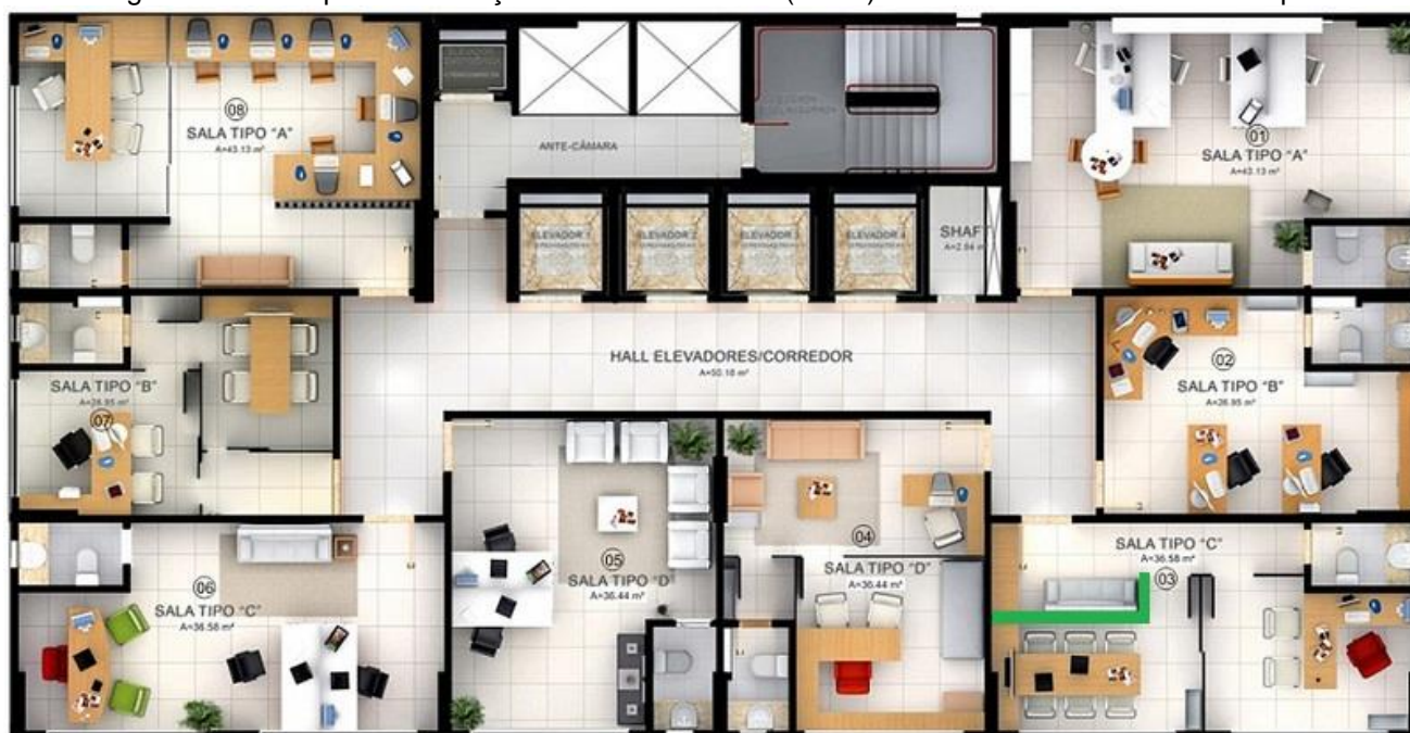
Figura 3.10 - Grupo 6 de vedações verticais internas (verde) avaliadas nos ensaios em campo.
