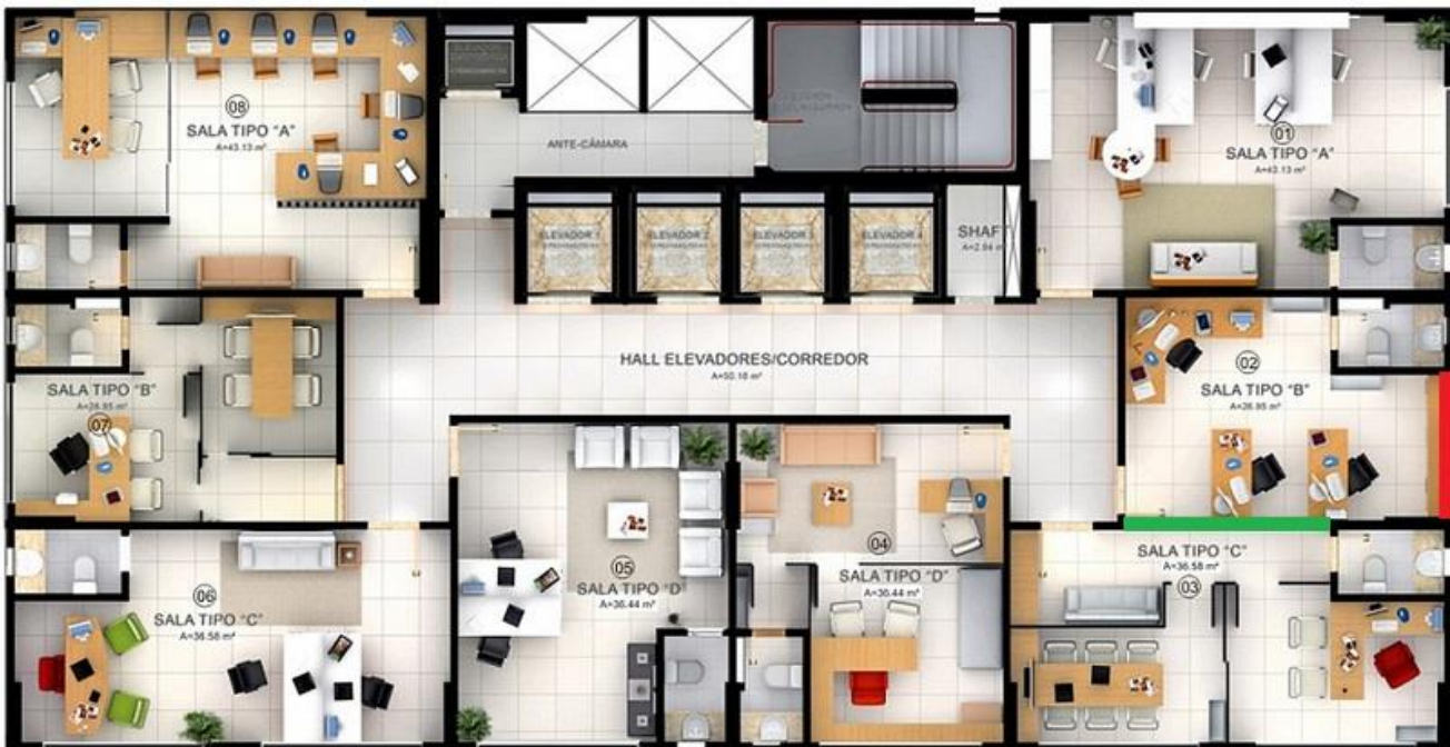
Figura 3.6 - Grupo 2 de vedações verticais internas (verde) e externas (Vermelho) avaliadas nos ensaios em campo.
