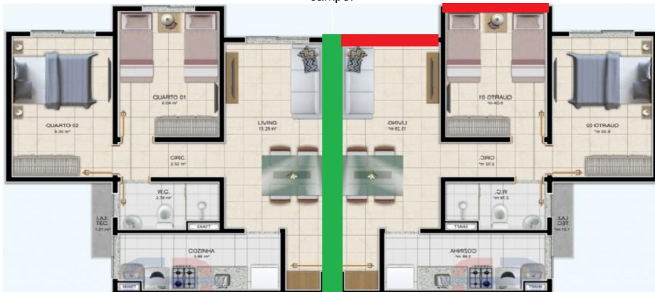
Figura 3.8 - Grupo 4 de vedações verticais internas (verde) e externas (Vermelho) avaliadas nos ensaios em campo.
