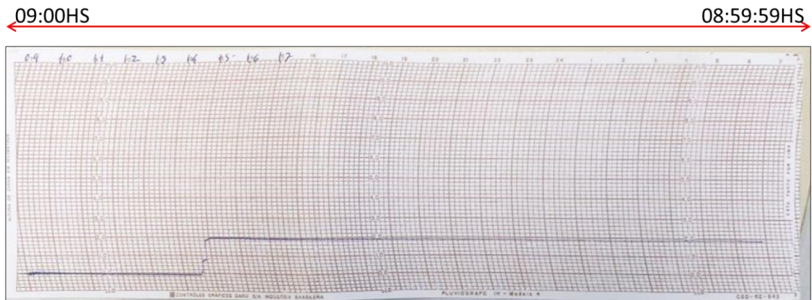
Figura 18 – Visualização da amplitude temporal utilizada nos pluviogramas da estação avaliada.
