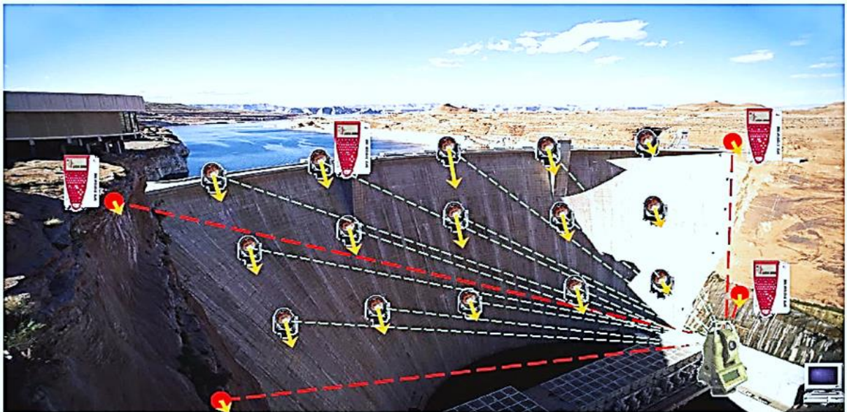
Figura 9: Integração entre sistemas para monitoramento de estruturas: GPS e Estações Totais
