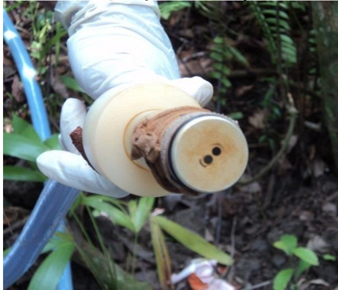
Figura 20 – Sensor de Turbidez para medida da quantidade de sedimentos.
