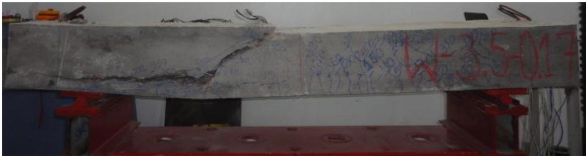
c) Viga após o ensaio
