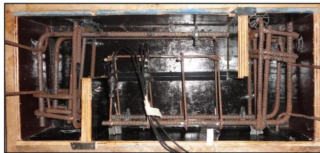
O espécime Wc foi fabricado com a mesma armadura do espécime W, porém com o acréscimo da armadura complementar utilizada nas vigas do grupo “Wc”, com o intuito de evitar a delaminação, sendo conectada a uma barra de aço CA 50 com 20 mm de diâmetro, como utilizada no espécime C. O embutimento dessa peça foi de 60 mm, sem considerar a armadura complementar e a barra longitudinal, conforme mostra Figura 3.37, assim como a armadura pode ser visualizada na Figura 3.38
