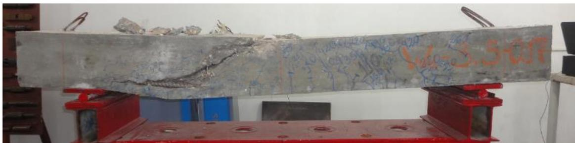
c) Viga após o ensaio
