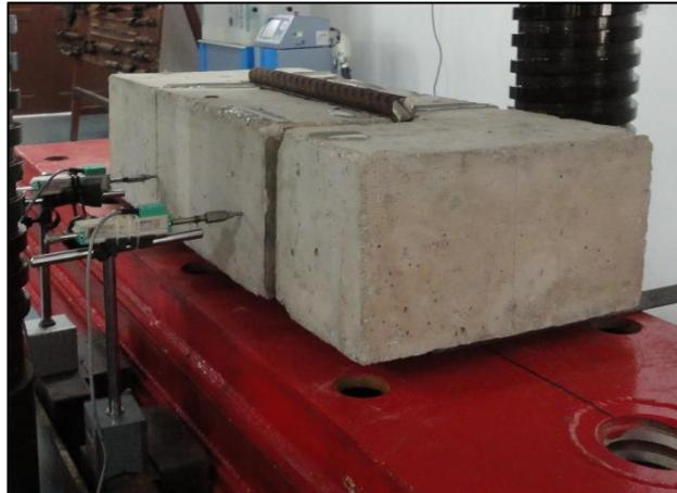
Após a pré-fissuração, as peças foram posicionadas verticalmente, apoiadas sobre uma chapa que estava apoiada sobre 4 roletes com 40 mm de diâmetro cada, e carregadas pela prensa universal, que possui um sistema de rótula. Esse sistema foi essencial para possibilitar o deslocamento horizontal entre as duas partes da peça, permitindo que a fissura se abrisse sem restrição. A Figura 3.43 mostra uma peça sendo ensaiada.
