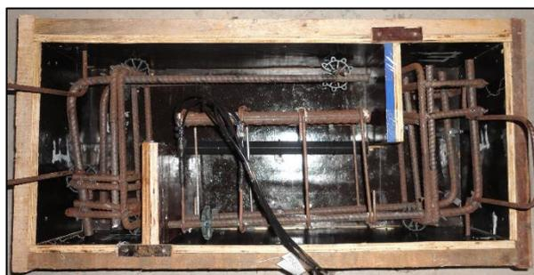
A armadura de cisalhamento da peça S é a mesma utilizada nas vigas do tipo “S”, fabricada da mesma forma e com o mesmo espaçamento, 125 mm, porém nessa, os trilhos possuem apenas 3 studs com embutimento de 60 mm. A Figura 3.33 mostra o detalhe da armadura transversal do espécime S, enquanto que a Figura 3.34 mostra a armadura da referida peça posicionada dentro da fôrma.
