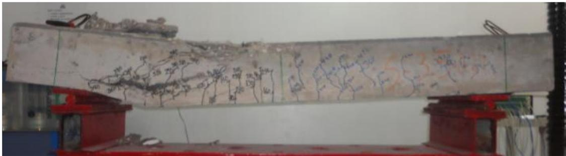
c) Viga após o ensaio
