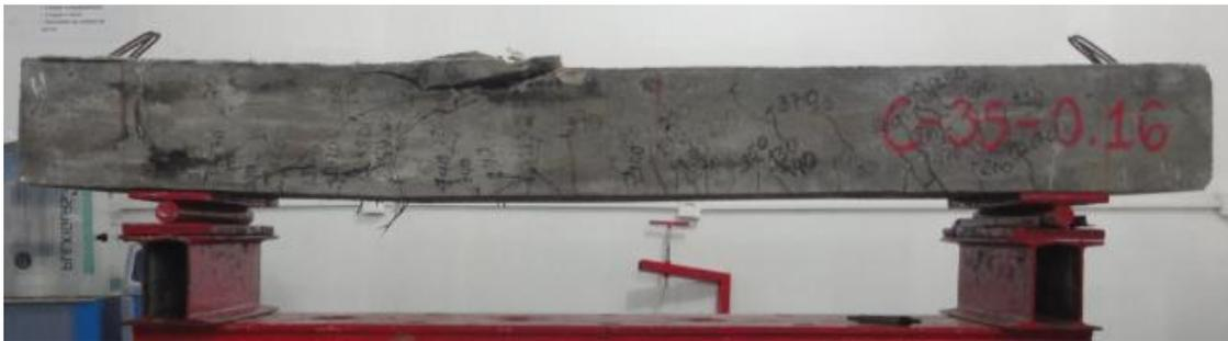
c) Viga após o ensaio
