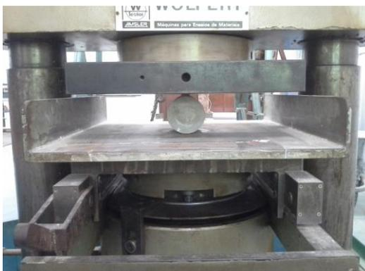
Figura 3.48 - Ensaio de módulo de elasticidade do concreto
