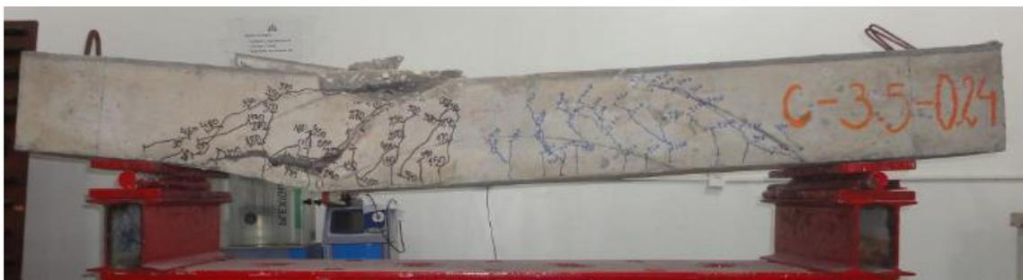
c) Viga após o ensaio
