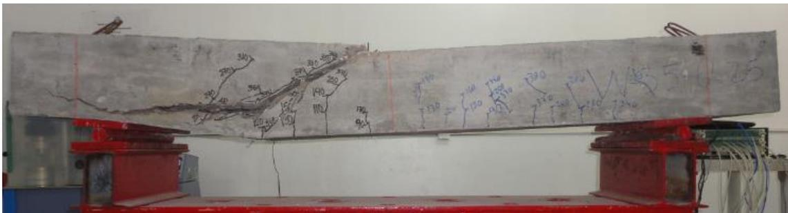
c) Viga após o ensaio
