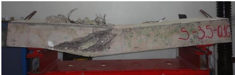
c) Viga após o ensaio
