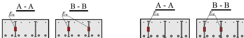
b) Seção transversal da viga S-3.5-0.16
