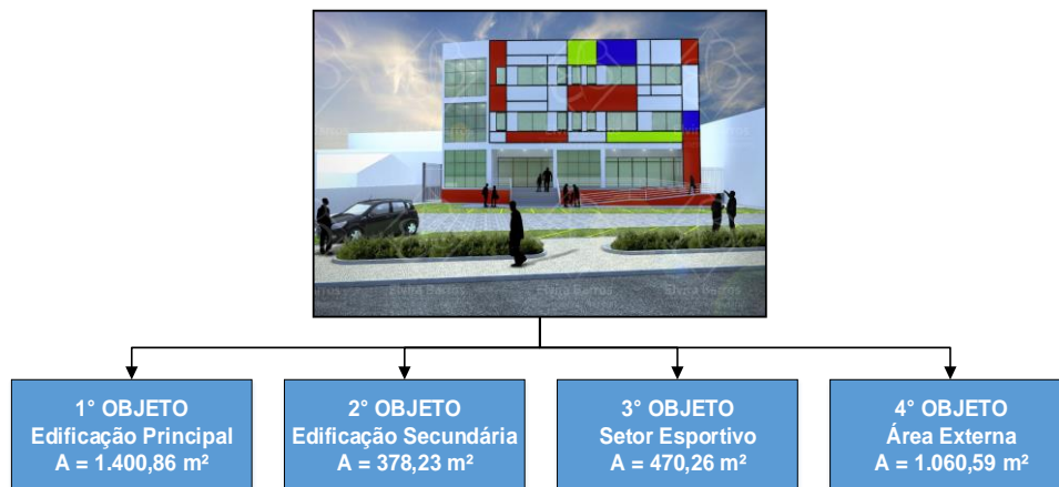
Figura 4.2: Divisão do projeto em quatro objetos construtivos.
