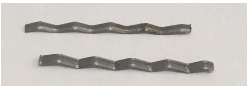
Figura 4.8 – Fibras corrugadas ( crimped ).
