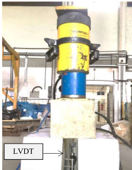
Figura 5.1 – Posicionamento do sistema de carregamento e LVDT do ensaio POT.
