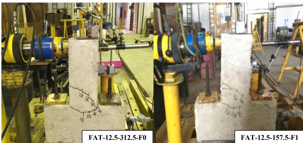
Figura 5.12 – Mapeamento da fissuração: a) amostras de \phi 8 mm; b) amostras de \phi 10 mm; e c) amostras de \phi 12,5 mm.
