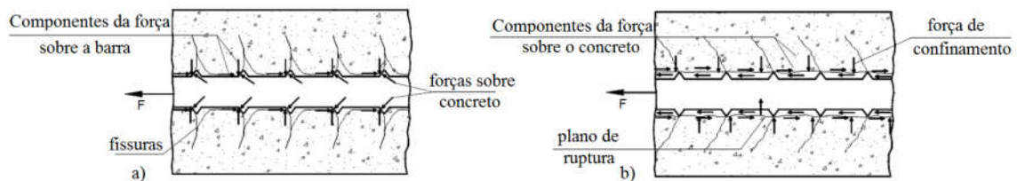
Figura 2.26 – Esquemático das forças e fissuras nos modos de ruptura: a) rupturas pelas fissuras de fendilhamento; b) rupturas dos consolos por cisalhamento e consequente arrancamento da barra (FUSCO, 2000).
