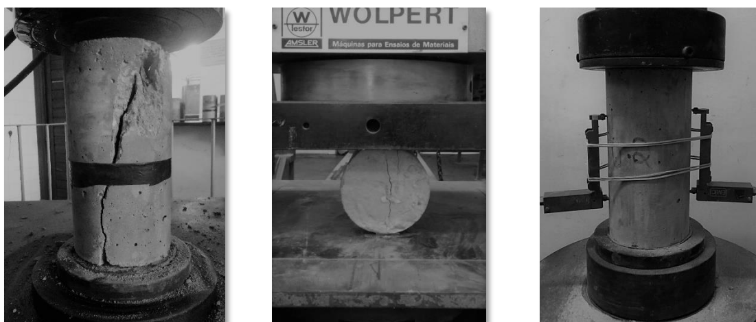
Figura 4-1 – Ensaio de caracterização dos materiais: a) – Compressão axial ; b) - Tração por compressão diametral ; c) - Módulo de elasticidade
