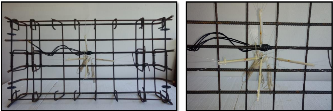
Figura 3-9 – Extensometria da armadura de flexão e cone de concreto
