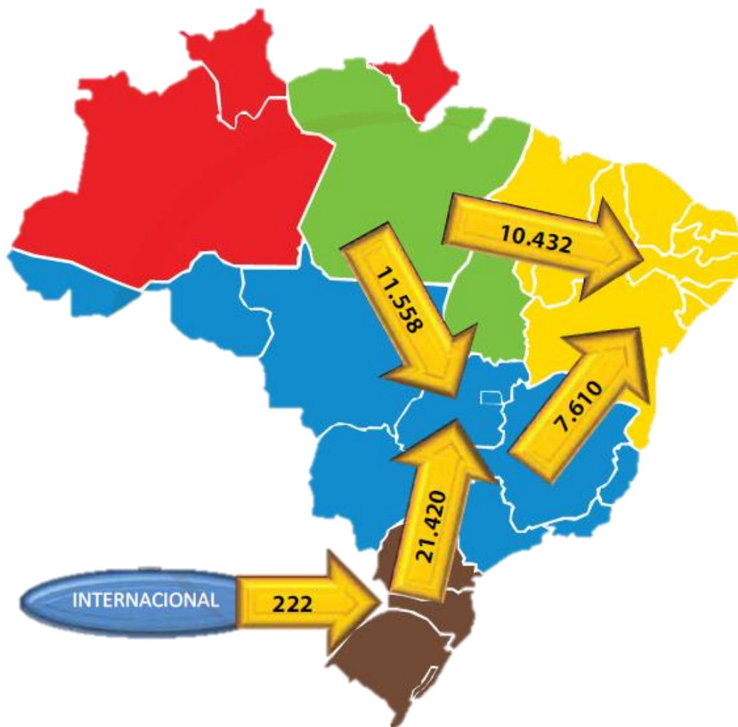
Figura 35- Intercâmbio de Energia elétrica entre as regiões do SIN em 2015 (MW médio) (Fonte: ONS apud EPE, 2016).
