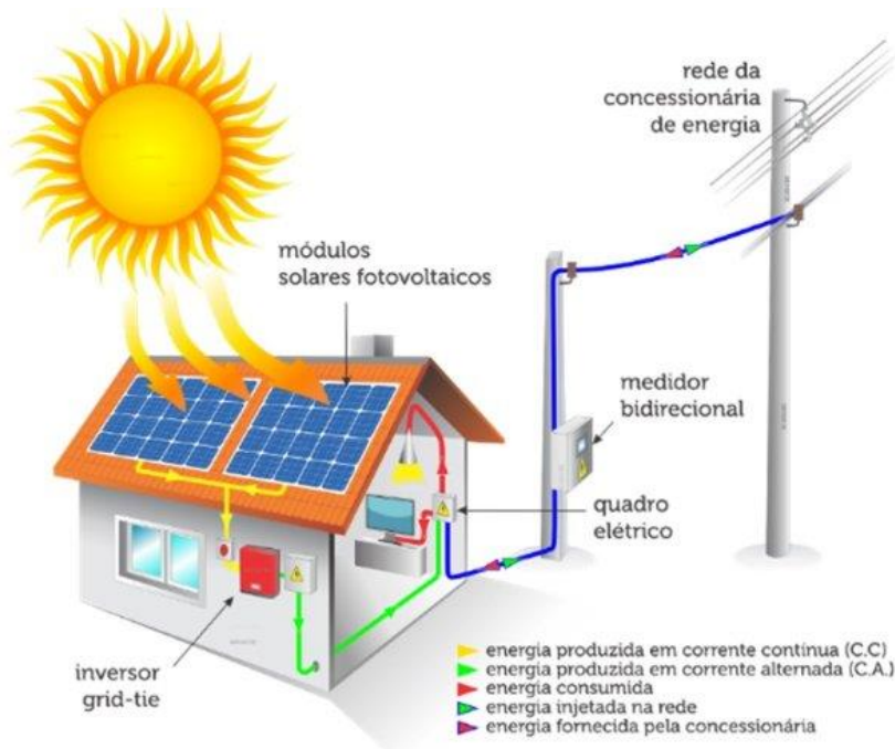
Figura 20- Ciclo Sistema Fotovoltaico. Fonte: https://pt.linkedin.com/pulse/energia-solar-fotovoltaica-e-termica-henrique-campos
