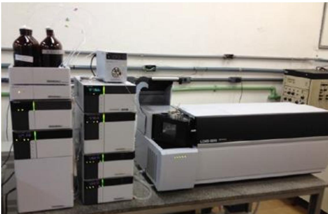
Figura 28 - Sistema de Cromatografia Fase Líquida acoplado à Espectrometria de Massas - HPLC- LC-MS/MS 8040 (Shimadzu).
