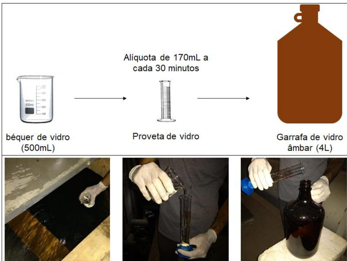
Figura 20 - Esquema do procedimento de coleta do ponto 2 (AF).
