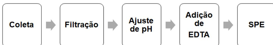
Figura 21 - Procedimento de preparação das amostras de fármacos.
